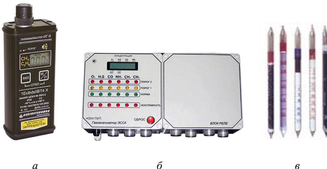
*Рис. 3.1. Газоанализатор переносной ИГ-9 для измерения концентрации метана и пропана (а), газоанализатор стационарный ЭССА для измерения содержания оксида углерода, метана, кислорода, сероводорода и аммиака в воздухе рабочей зоны (б), индикаторные трубки (в)*
