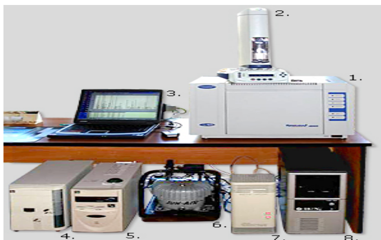
Рис. 3.85 представлен автоматизированный газовый хроматограф 1 — хроматограф; 2 — автоматический дозатор жидких проб; 3 — ПК для управления работой хроматографа через серийный интерфейс; 4 — компрессор воздуха; 5 — генератор водорода; 7 — фильтр каталитической очистки; 8 — генератор азота;
