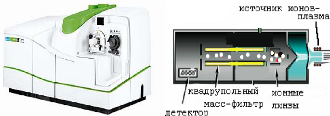
Рис.3.68. Внешний вид ИСП-МС седьмого поколения NexION 300 и схема, показывающая принцип его работы
