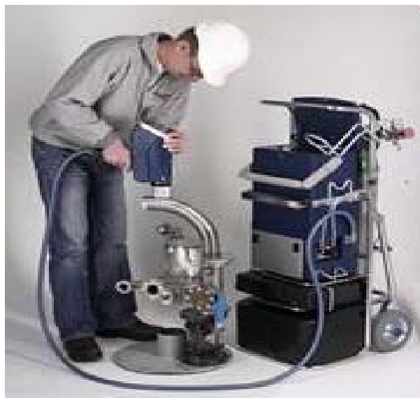
Рис.3.22. Мобильный атомно-эмиссионный спектрометр ARC-MET 8000
