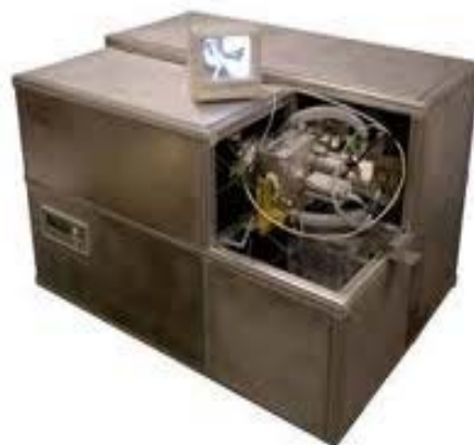
Рис.3.59. Принципиальная схема времяпролетного масс-анализатора и внешний вид настольного времяпролетного масс-спектрометра
