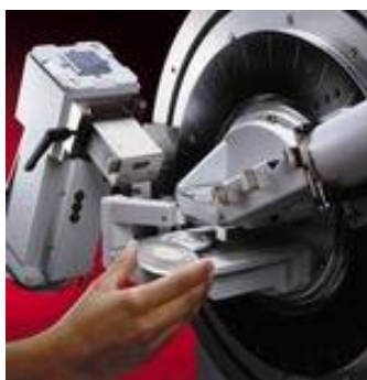
Рис. 3.98 Основные блоки рентгеновского дифрактометра D8 FOCUS для качественного и количественного фазового анализа методом порошковой дифрактометрии
