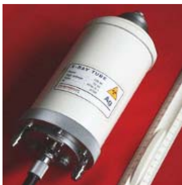
Рис. 3.36. Внешний вид импульсной рентгеновской трубки с анодом из серебра с замкнутой системой водяного охлаждения
