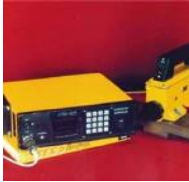
Рис. 3.53. Анализатор рентгенорадиометрический РПП-105 для экспрессного одновременного определения содержания до 5 химических элементов с атомными номерами от 19 (калий) до 82 (свинец)
