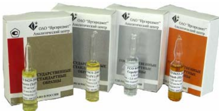
Рис.1.3. Стандартные образцы состава растворов благородных металлов с аттестованными значениями массовых концентраций ионов золота, серебра, платины, палладия
