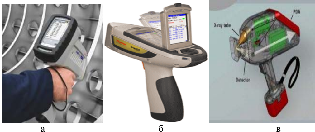
Рис. 3.49. Внешний вид портативного рентгено-флуоресцентного анализатора X-MET 5100 (а), Niton XI3t GOLDD (б) и пистолетный анализатор в разрезе (в)
