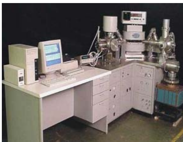
Рис.3.65. Масс-спектрометры серии МИ-1201
