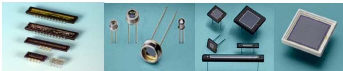
Рис.3.7. Внешний вид CCD детекторов и фотодиодных матриц для детектирования сигналов в разных областях длин волн
