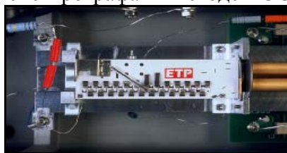
Рис.3.60. Внешний вид двухстадийного детектора с дискретными динодами
