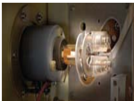
Рис. 3.15. Внешний вид атомизатора ИСП с индукционными пластинами и изображение плазмы в таком атомизаторе
