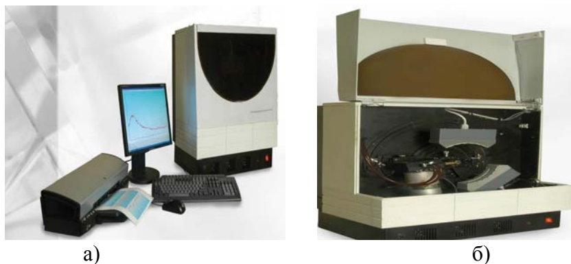
Рис.3.101. Рентгеновский микродифрактометр Дифрей-100 μ (а), его рентгенооптическая схема и микрофокусная рентгеновская трубка (б)
