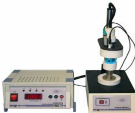
Рис. 3.75 Вольтамперометрический анализатор тяжелых металлов (полярограф)
