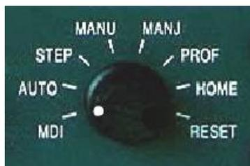
Рис. 2.11. Переключатель режимов работы станка
