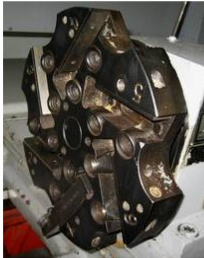
Рис. 2.3. Шестипозиционная револьверная головка
