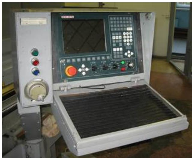
Рис. 2.5. Общий вид стойки (устройства ЧПУ) NC-201
