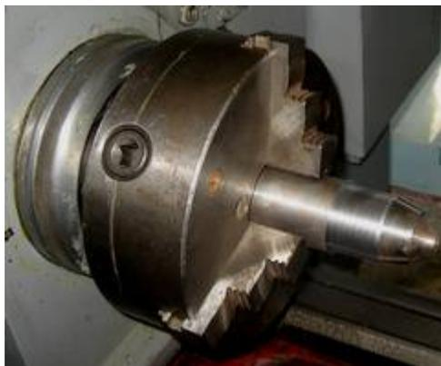
Рис. 2.4. Трехкулачковый патрон с зажатой деталью
