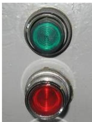
Рис. 2.7. Кнопки включения и выключения станка с ЧПУ
