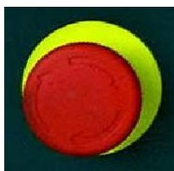
Рис. 2.12. Кнопка **аварийный останов**
