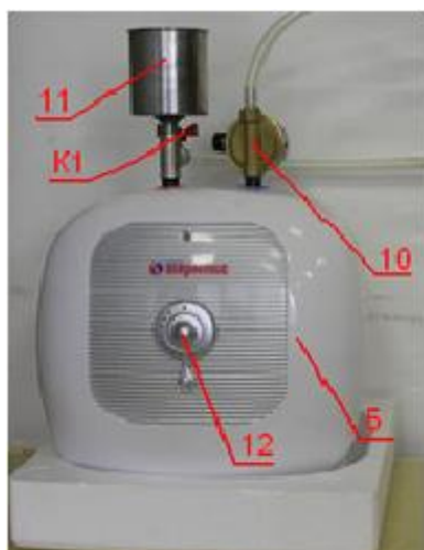
Рис.35.1. Блок термостата с циркуляционным насосом
