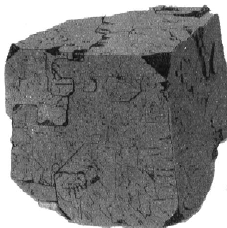
*Рис. 71. Блоковое строение кристалла галенита*
