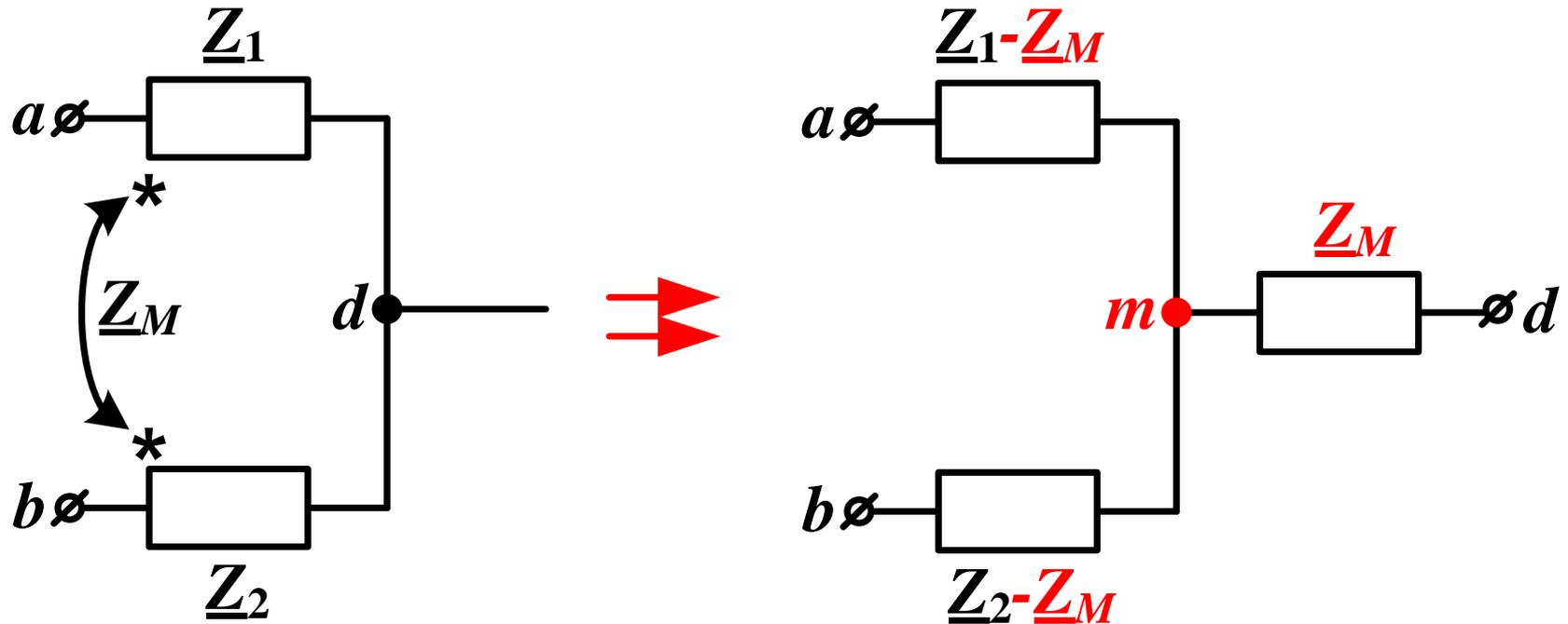
2. Два индуктивно связанных комплексных сопротивления ( $\underline{Z}_1, \underline{Z}_2$ ) при  $\underline{Z}_M = jX_M = j\omega M$  подходят различным образом к общему узлу ( $d$ ):
