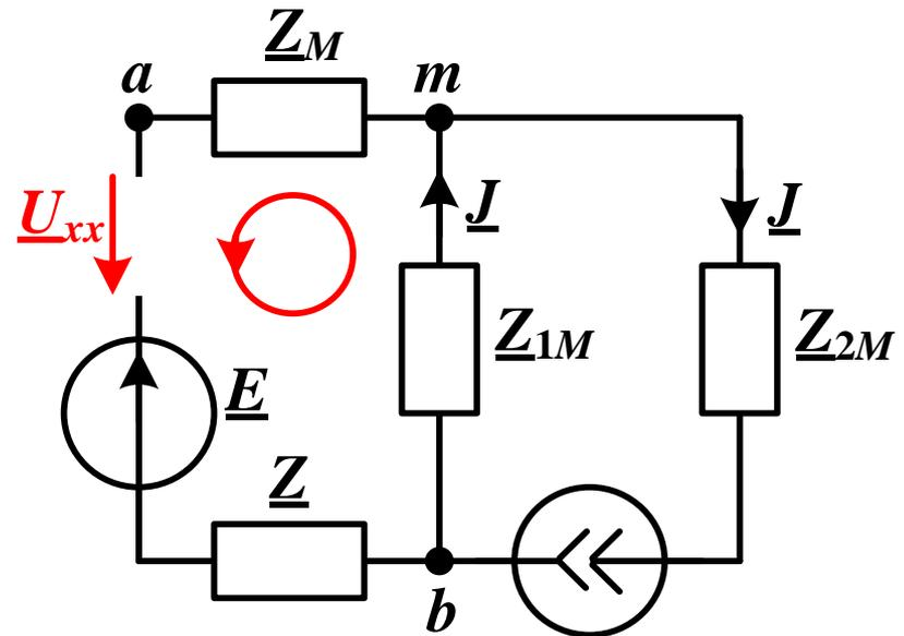
б) сопротивление эквивалентного генератора  $\underline{Z}_\Gamma = ?$
