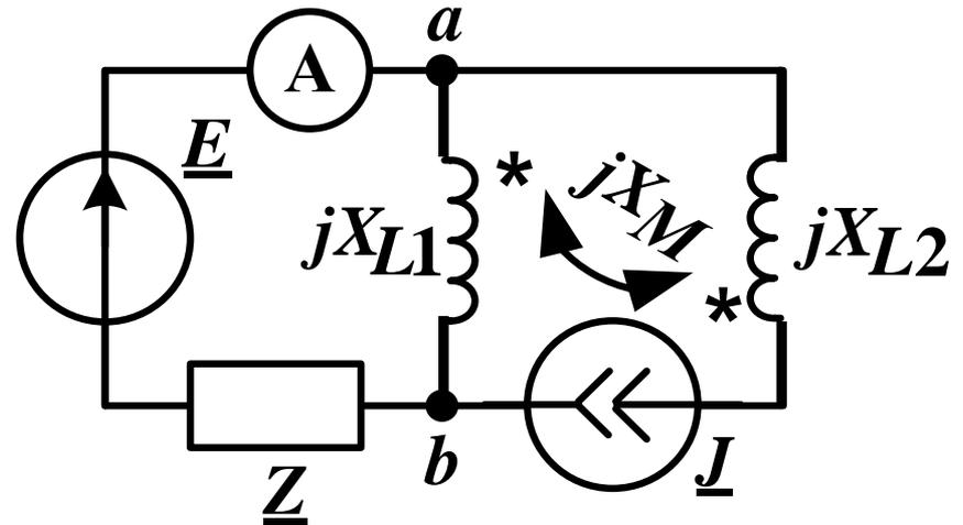
1. Развязка, когда два индуктивно связанных сопротивления подходят различным образом к общему узлу (*a*):
