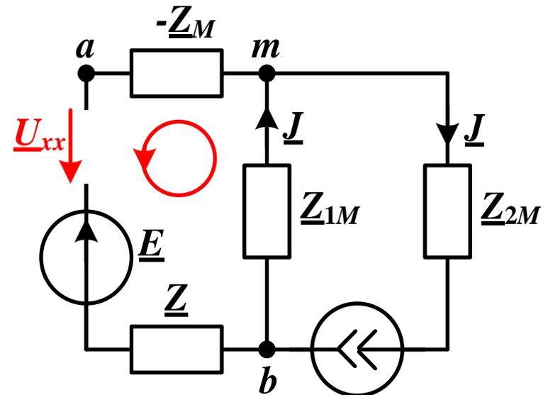
б) сопротивление эквивалентного генератора  $\underline{Z}_\Gamma = ?$
