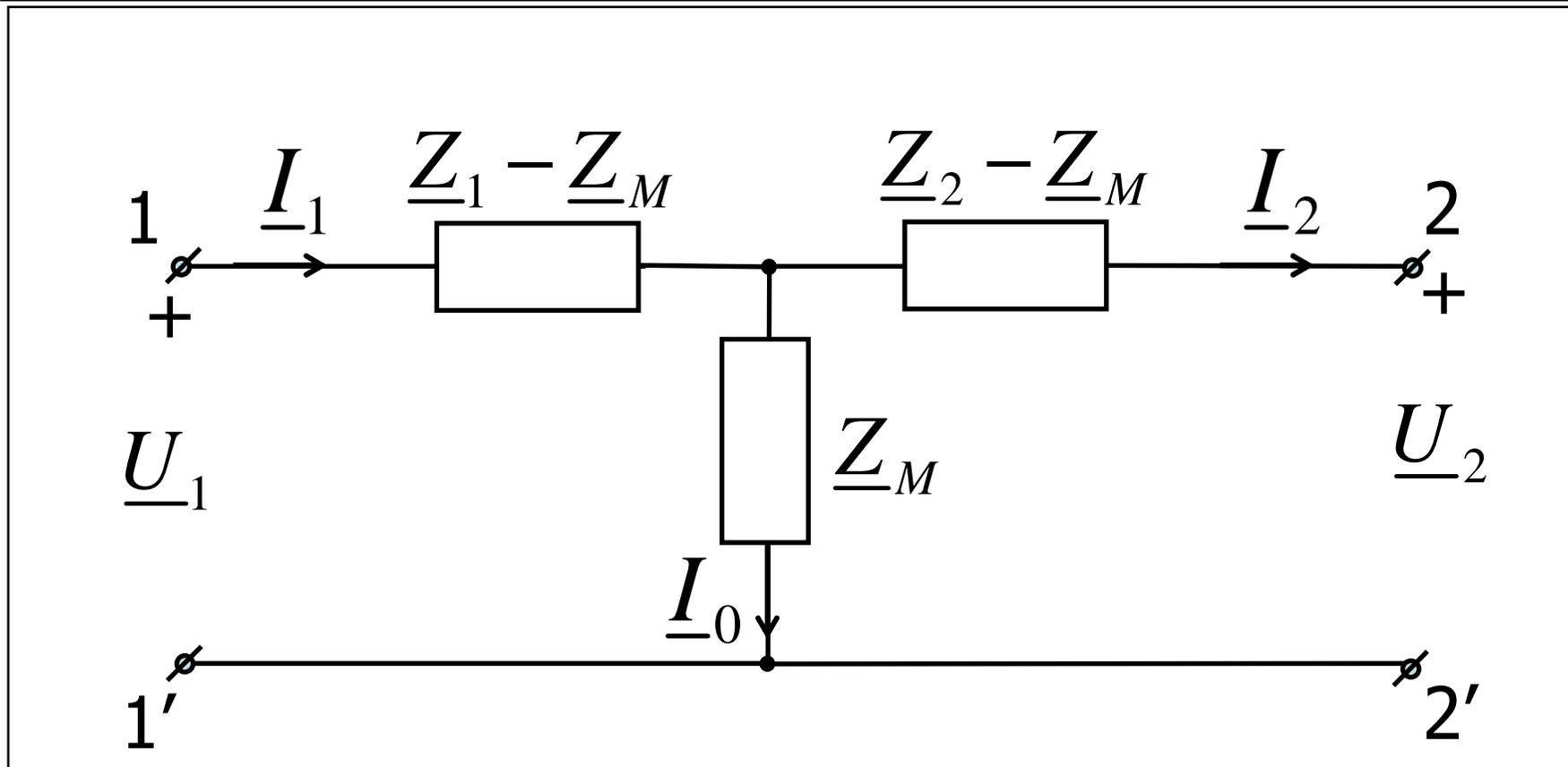
$\underline{I}_0 = \underline{I}_1 - \underline{I}_2$  - ток намагничивания создает  $\Phi$
