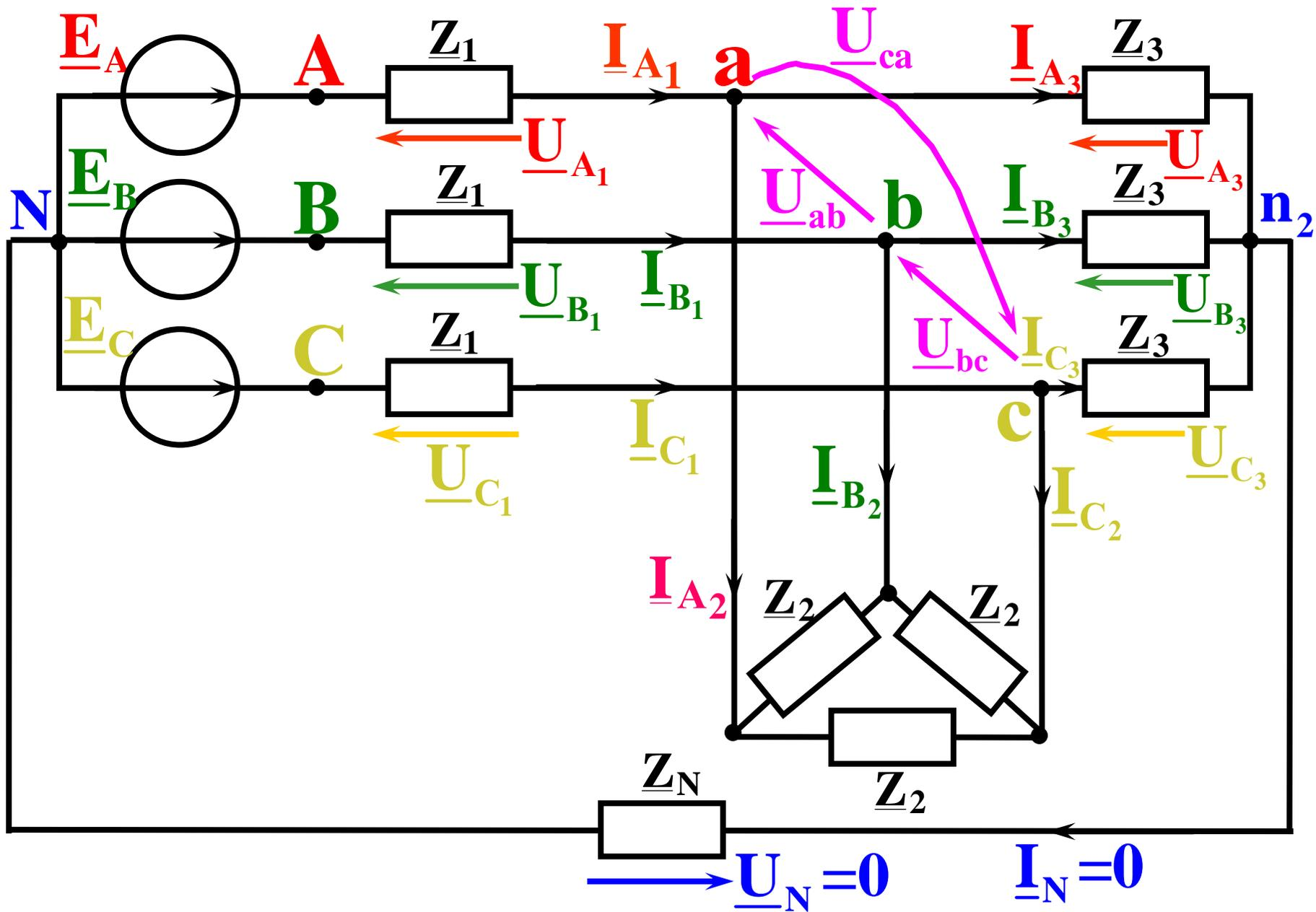
**В симметричном режиме** расчет сложной трехфазной цепи после преобразования **треугольника** в **звезду** ведется на **одну фазу (А)** **любым известным методом** в комплексной форме, затем при помощи фазового оператора ( $a=1e^{j120^\circ}$ ) находятся токи и напряжения других фаз
