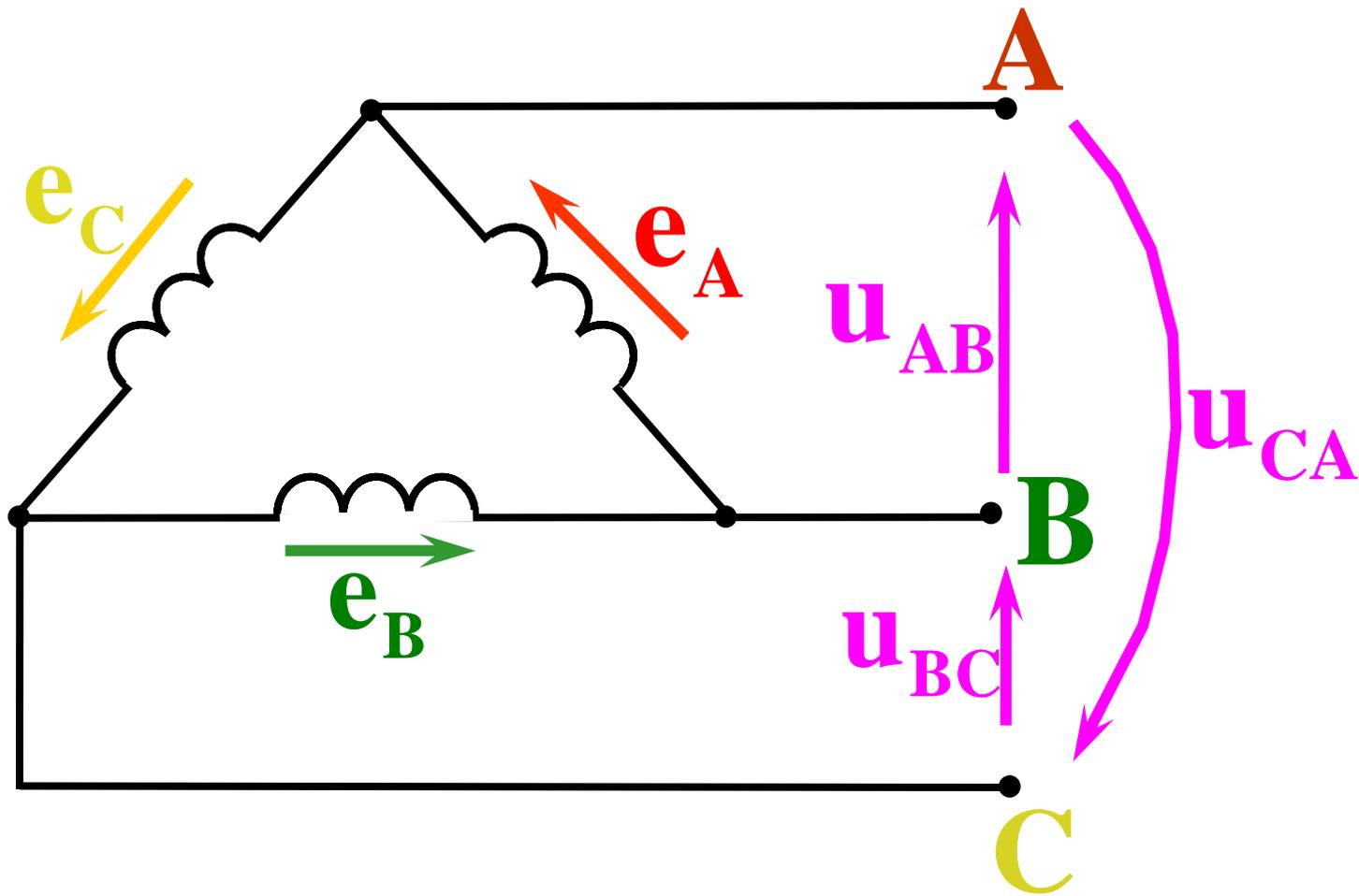
В **нормальном** режиме фазные ЭДС генераторов и трансформаторов образуют **симметричную систему**, т.е. имеют **одинаковую гармоническую форму**, одинаковые **частоту и амплитуду** и сдвинуты по фазе относительно друг друга на **120 градусов**
