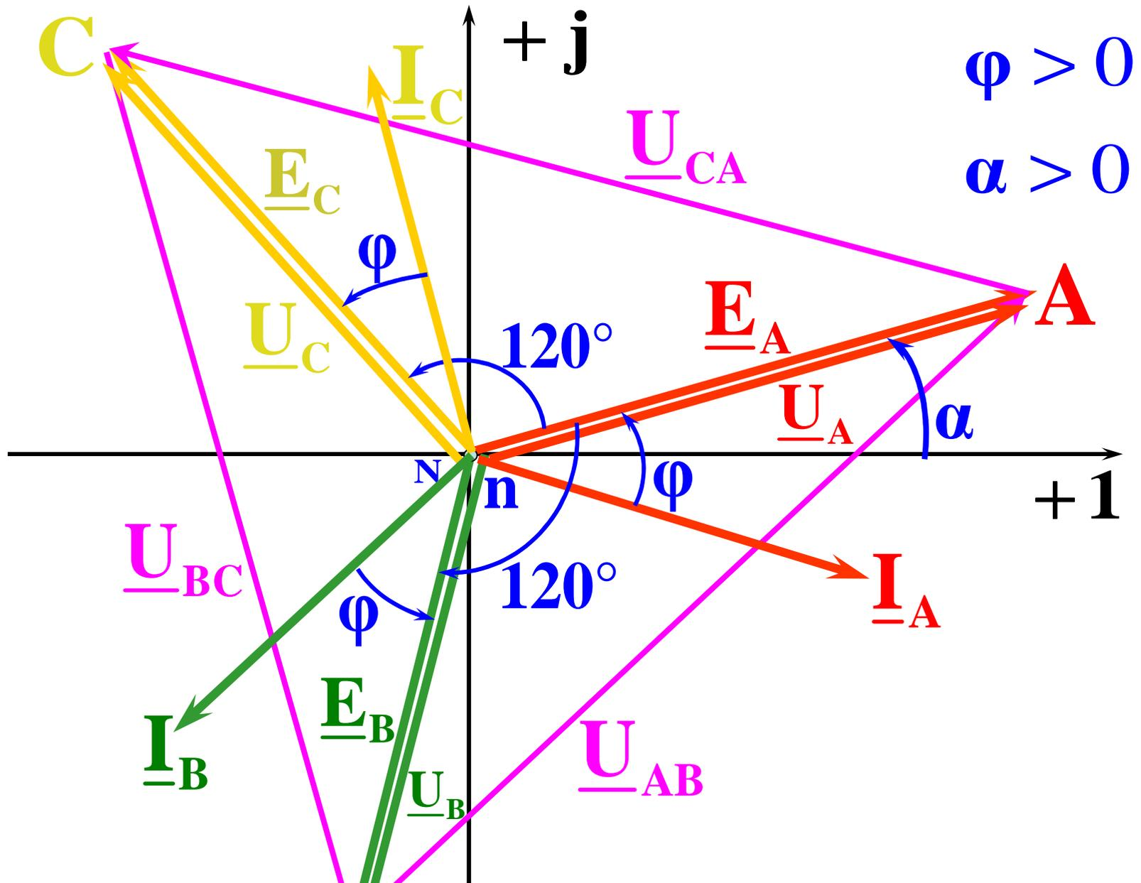
**В симметричном режиме ток нулевого провода  $\underline{I}_N$  и напряжение смещения нейтралей  $\underline{U}_N$  равны нулю, поэтому цепь без нулевого провода рассчитывается аналогично, причем такой расчет можно вести на одну фазу (А)**
