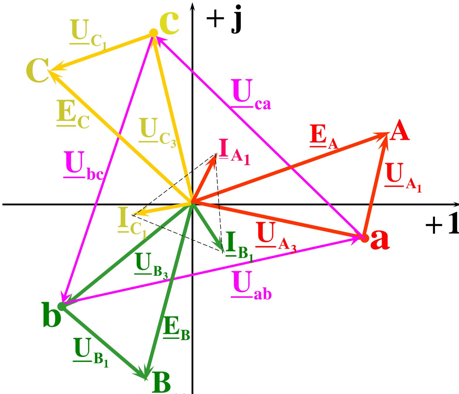
Сложную трехфазную цепь в симметричном режиме можно преобразовать до эквивалентной звезды:
