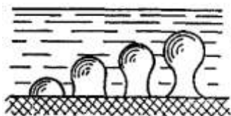
Рис. 9.9. Схема роста пузырька, сидящего на поверхности твердого тела
