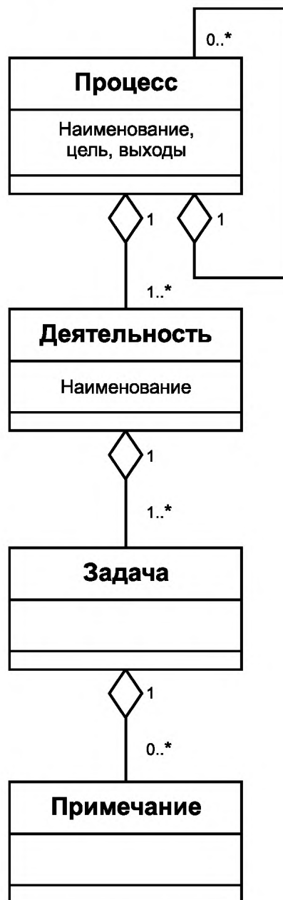
Рисунок С.1 — Конструкции процессов в ИСО/МЭК 12207 и ИСО/МЭК 15288
