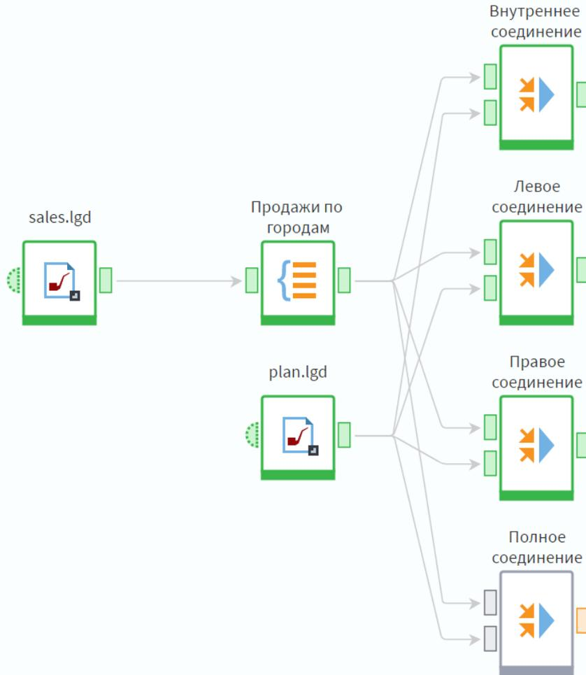
Теперь рассмотрим **Полное соединение**. Оно позволяет соединить каждую строку одной таблицы с каждой строкой второй таблицы, давая в результате все возможные сочетания строк. Это может понадобиться, например, в случае необходимости сравнить каждую строку одного набора с каждой строкой другого с помощью расстояния Левенштейна между строками.
