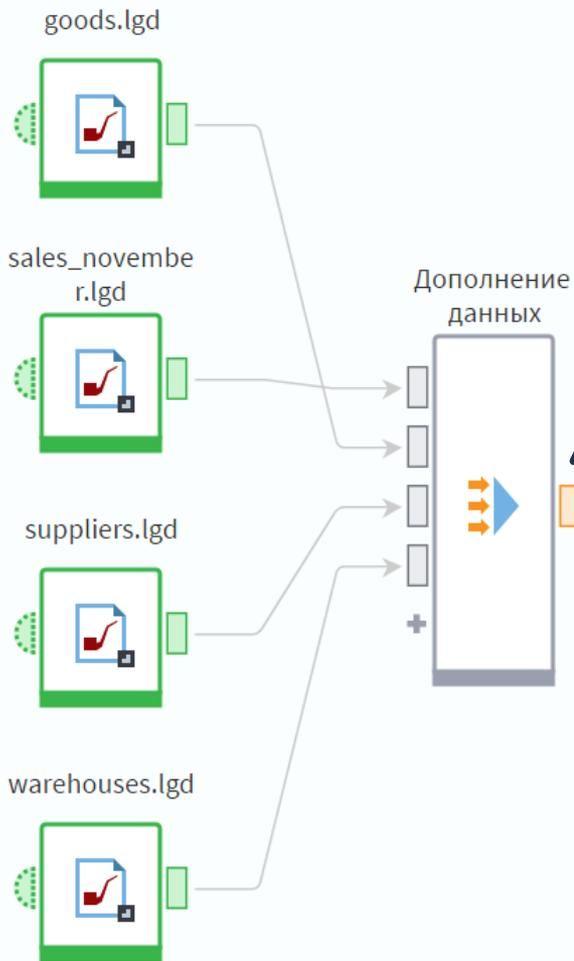
Добавим в область построения узел **Дополнение данных**. По умолчанию он имеет два входных порта. Для того, чтобы добавить дополнительные порты, можно нажать кнопку **Добавить еще один порт** или протянуть к этой кнопке связь от выходного порта другого узла. Подадим на входы все наши наборы данных, для удобства переименуем порты и перейдем в настройку узла.
