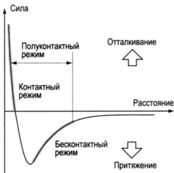
Рис. 6.6. Схема характера поведения сил Ван-дер-Ваальса и режимов работы АСМ
