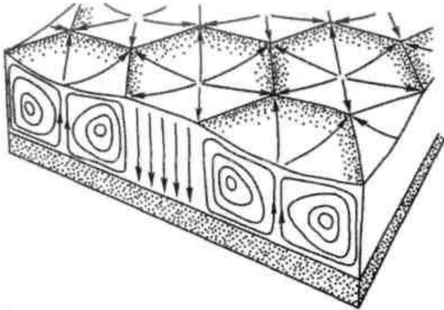
Возникновение шестигранных ячеек Бенара в тонком слое жидкости. Сверху – линии тока жидкости в режиме конвекции Бенара.
