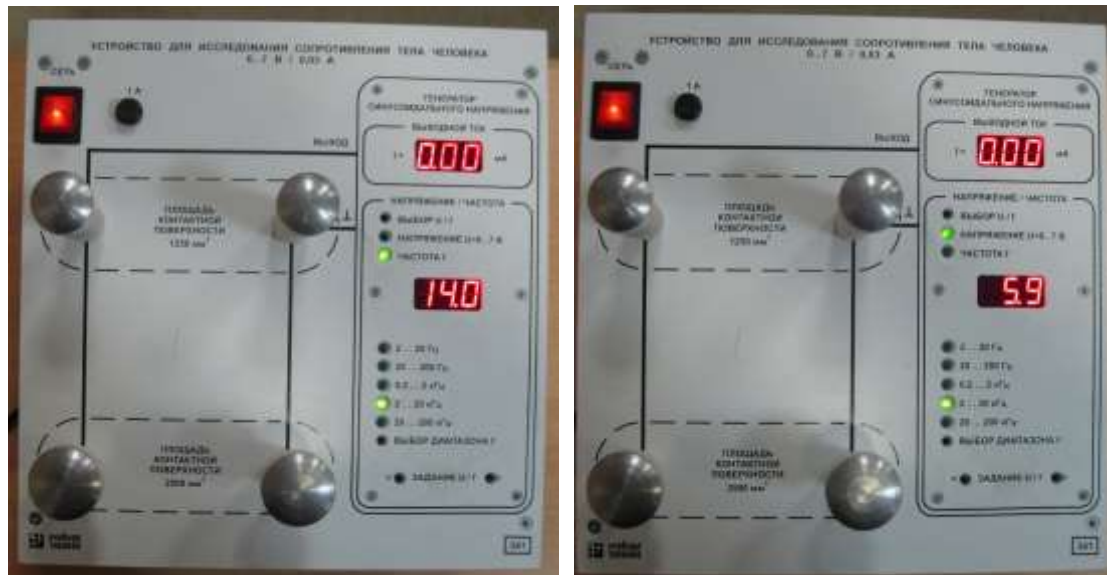
Рис. 10.1. Внешний вид лабораторного стенда по исследованию сопротивления тела человека (слева — в режиме задания частоты, справа — в режиме задания амплитуды)
