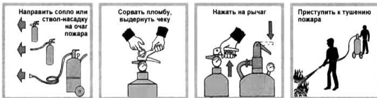
Рис. 2.12. Приведение в действие порошкового огнетушителя закачного
