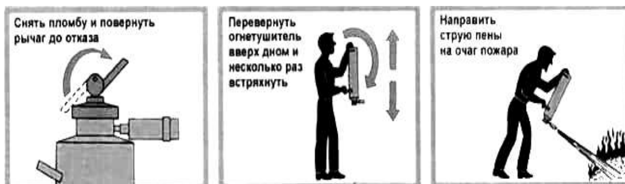
Рис. 15. Приведение в действие химического пенного огнетушителя
