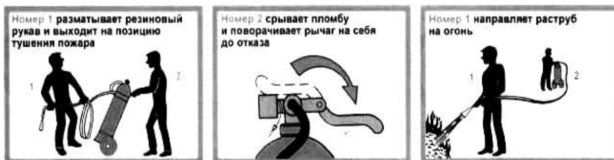
Рис. 2.8. Приведение в действие передвижного углекислотного огнетушителя
