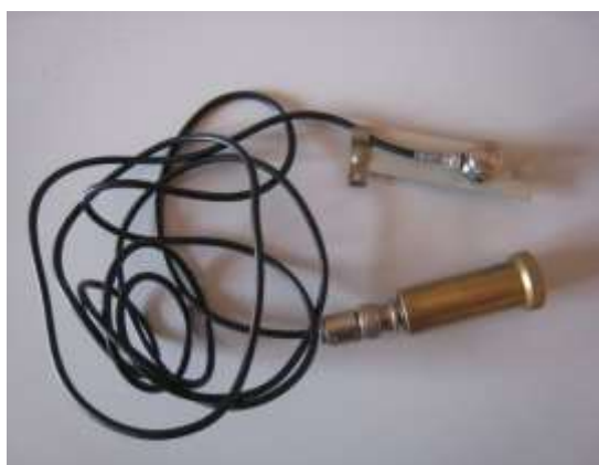
Рис. 7.13. Вибропреобразователь на металлической пластине с проводом и эквивалентом микрофонного капсуля.
