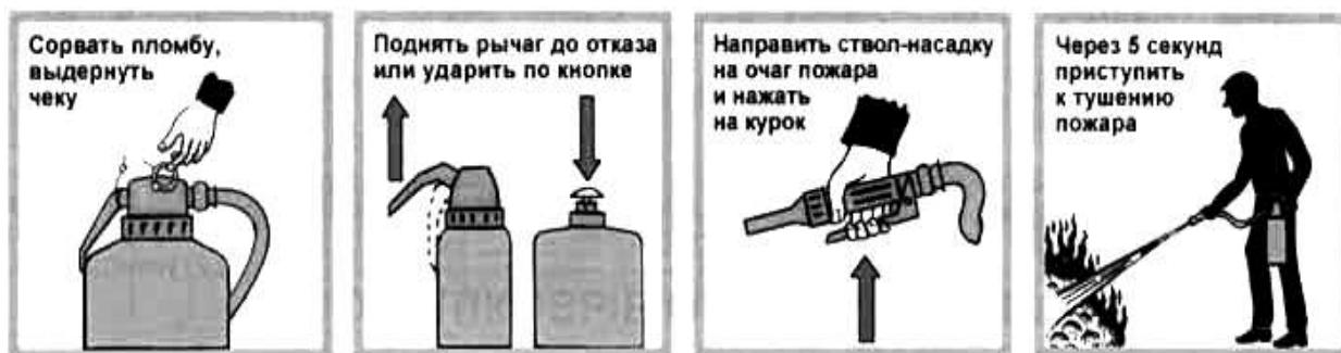
Рис. 2.13. Приведение в действие порошкового огнетушителя со встроенным источником давления
