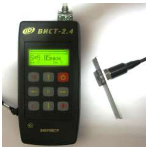
Рис. 7.14. Измеритель шума и вибрации ВИСТ-2.4 с вибродатчиком, закрепленном на алюминиевой пластине
