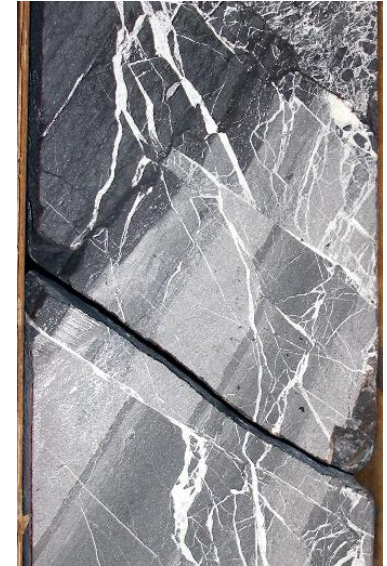
Прожилково-трещинная текстура со сдвиговыми деформациями
