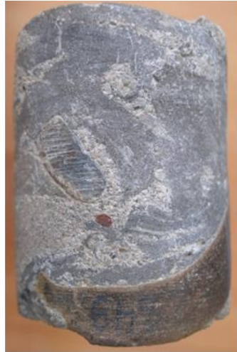
Беспорядочная текстура брекчии гидроразрыва
