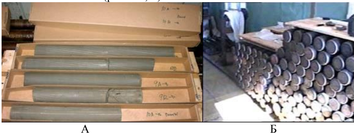
Рис. 3.2. Укладка керна в картонные коробки (А) и пластиковые пеналы (Б)
