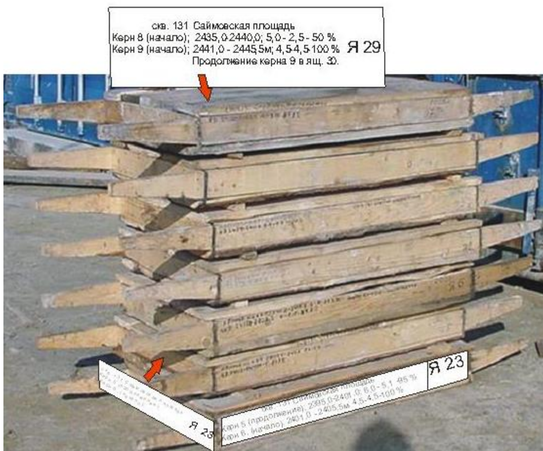
Рис. 3.6. Маркировка и штабелирование керновых ящиков
