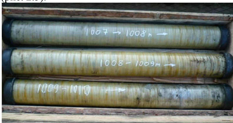
Рис. 2.5. Изолированный керн в стеклопластиковых трубах:
