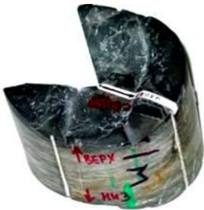
Рис. 2.4. Образцы ориентированного керна до (А) и после (Б) палеомагнитного анализа (стрелками обозначено направление севера)
