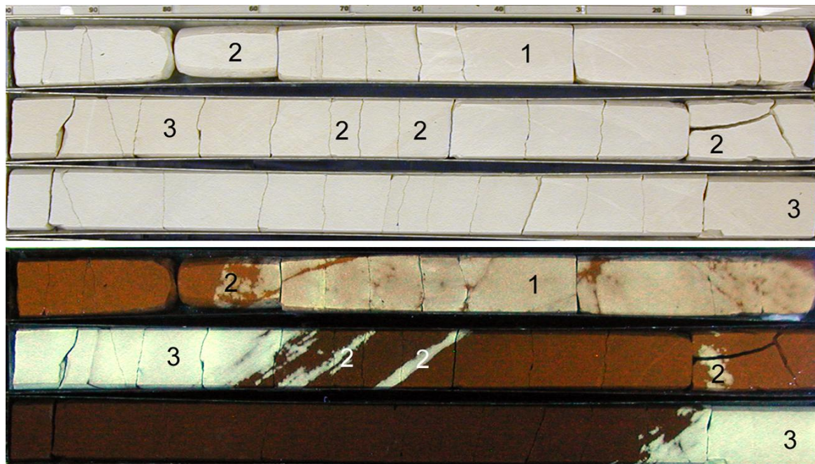
Рис. 4.4. Сложный характер нефтенасыщения и карбонатизации, определяемый по фотографиям в ультрафиолетовом свете [19] 1 – песчаник неравномерно нефтенасыщенный, неравномерно известковистый; 2 – пятно нефтенасыщения не ясно выраженное в дневном и ясно выраженное – в ультрафиолетовом свете; 3 – песчаник нефтенасыщенный
