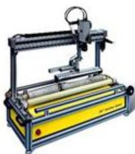
Рис. 4.1. Цифровая фотографическая система (А) и сканер керна (Б) [33]:
