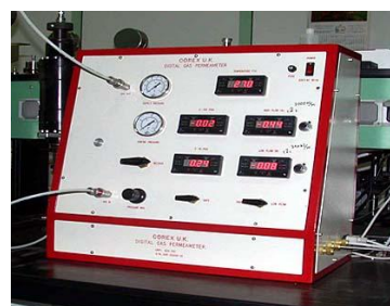
Зондовый пермеаметр Corex
