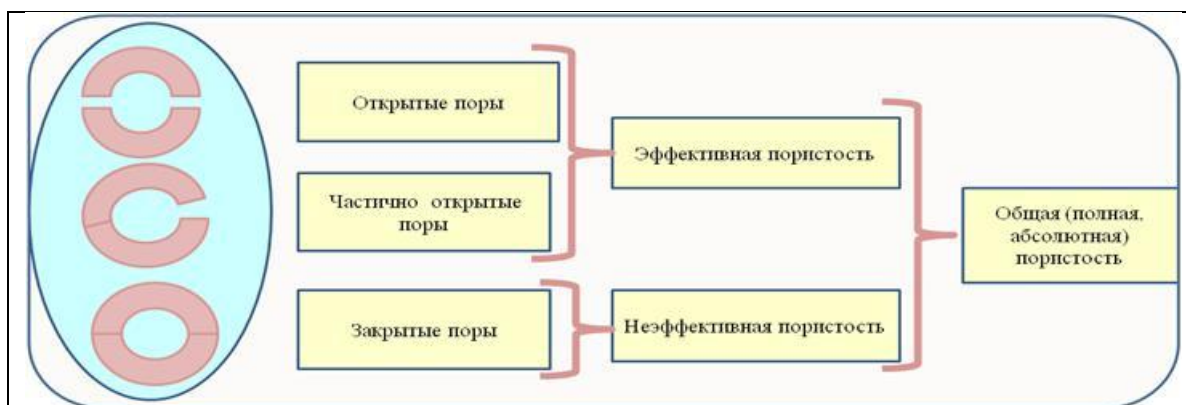
Рис. 81. Схема типов пор и пористости
