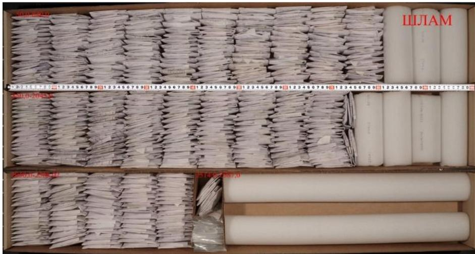
При хранении шлам укладывается в картонные коробки с соблюдением последовательности укладки по глубине
