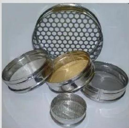
Используются сита с диаметром отверстий 2, 3, 5, 7 мм. |
