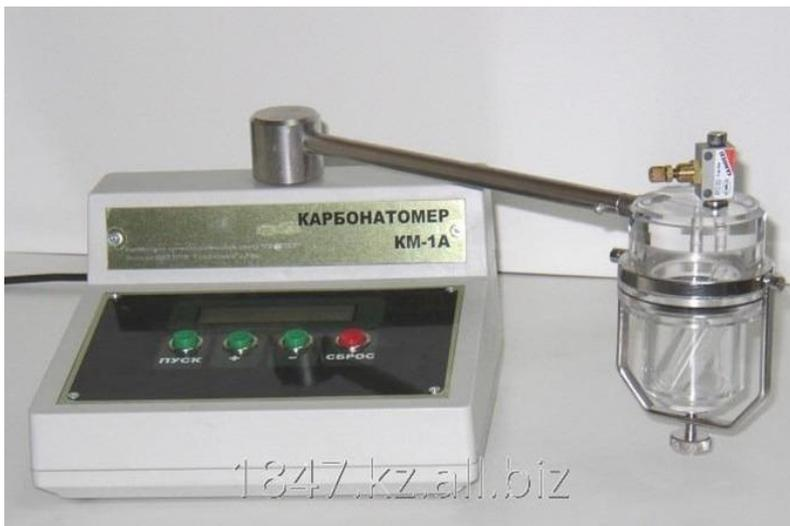
Метода основан на расчете объема углекислого газа, выделившегося при реакции кальцита и доломита с соляной кислотой. В результате анализа определяется процентное содержание кальцита, доломита и нерастворимого остатка в карбонатных отложениях. Анализ производится на карбонатомере, который может быть основан на весовом или манометрическом принципе.
