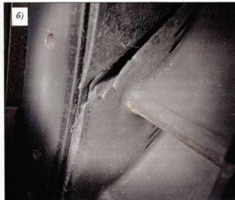
Фото 5. Высокотемпературные повреждения в виде коррозии, эрозии входных кромок и нижних полок лопаток. Сквозной прогар нижних полок направляющих лопаток ТВД
