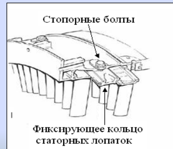
Методы крепления неподвижных направляющих лопаток на статоре
