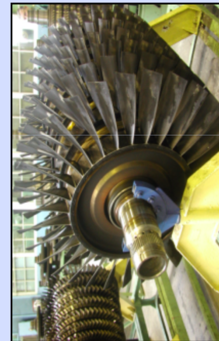
Ротор осевого компрессора с установленными на него рабочими лопатками
