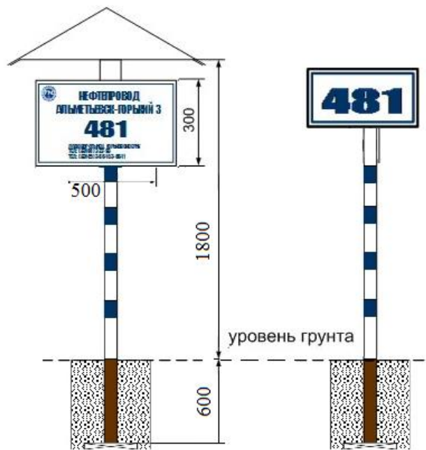
Рис.2. Общий вид опознавательного километрового знака (для чтения при вертолетном патрулировании) [65]
