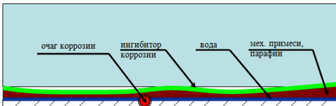
Рис. 5.16. Распределение ингибитора в сечении трубопровода
