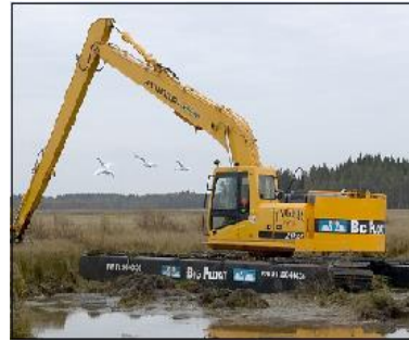
Рис. 1.7. Экскаваторы с сильно развитой опорной поверхностью [6]
