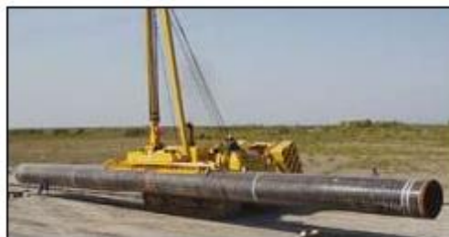
Рис. 2.10. Вакуумные присоски с двойными присосами для трубных секций на боковой стреле [11]
