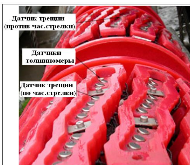
Рис. 5.31. Расположение датчиков на комбинированном ультразвуковом дефектоскопе
