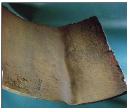
Рис. 4.4. Образование канавочной коррозии низконапорного водовода ОАО «Юганскнефтегаз»:
