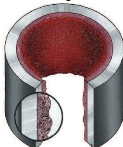
Рис. 4.33. Влияние шероховатости на процесс отложений парафина
