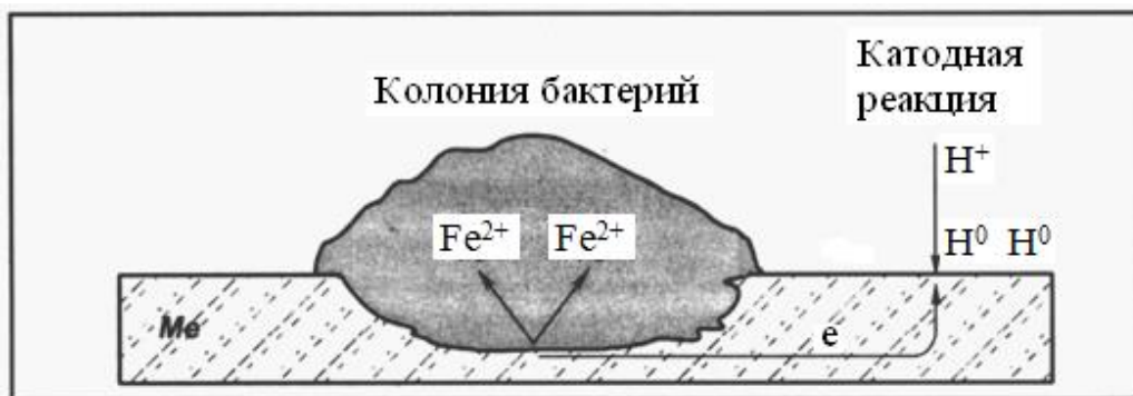
Рис. 4.11. Схематическое изображение роста язв под колонией бактерий
