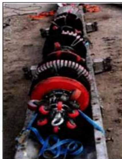
Рис. 5.38. Комбинированный магнитный дефектоскоп сверхвысокого разрешения с продольным и поперечным намагничиванием (ЗАО «Нефтегазкомплектсервис», г.Москва) [95]
