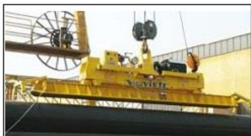
Рис. 2.9. Вакуумные присоски, работа с краном (одна подвеска) [11]
