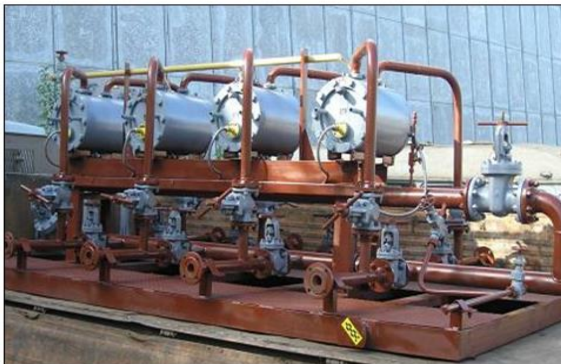
Рис. 3.11. Групповая замерная установка типа «Дельта» ОАО «Завод Нефтегазмаш» г. Саратов [28]
