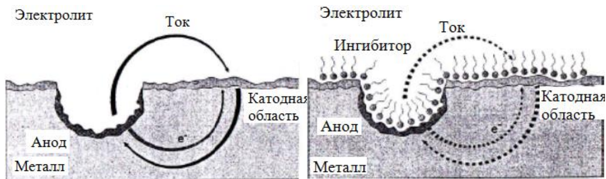
а) Процесс развития язвенной коррозии на поверхности стального изделия б) Подавление язвенной коррозии в результате адсорбции на металлической поверхности ингибитора коррозии
