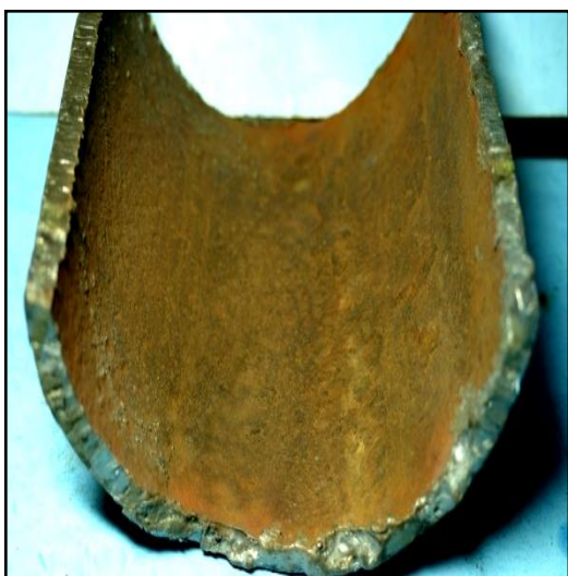
Рис. 4.5. Образование канавочной коррозии промышленного трубопровода ОАО НК «Роснефть-Пурнефтегаз»:
