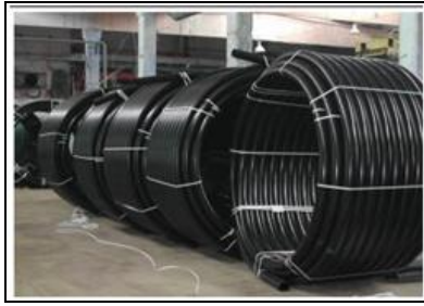
Рис. 1.25. Намотка полиэтиленовой трубы на катушку
