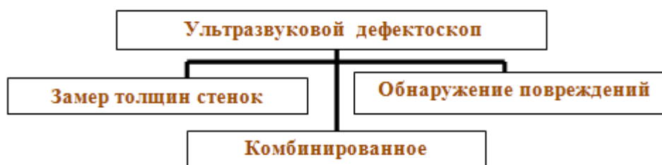
Рис. 5.27. Классификация ультразвуковых дефектоскопов по назначению
