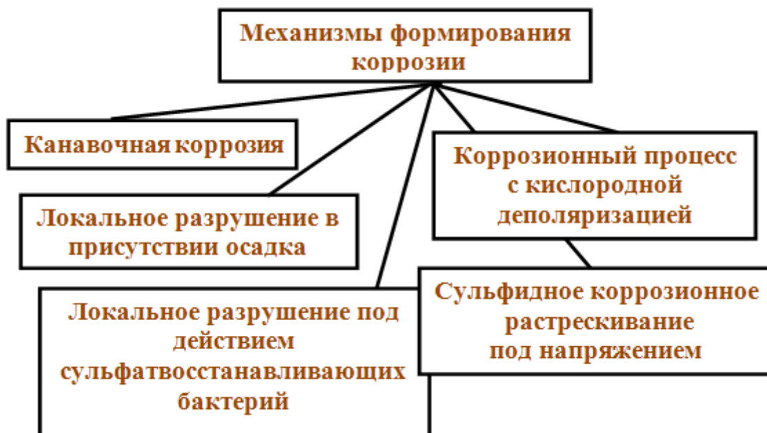
Рис. 4.2. Основные механизмы формирования коррозии
