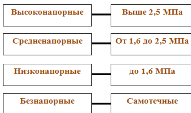
Рис. 1.15. Классификация нефтесборных трубопроводов по величине давления [5]
