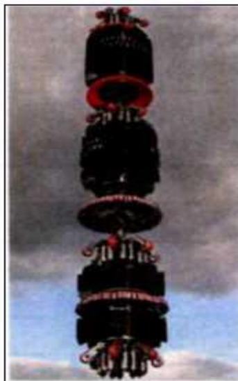
Рис. 5.38. Комбинированный магнитный дефектоскоп сверхвысокого разрешения с продольным и поперечным намагничиванием (ЗАО «Нефтегазкомплектсервис», г.Москва) [95]
