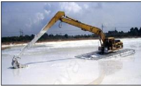
Рис. 1.7. Экскаваторы с сильно развитой опорной поверхностью [6]
