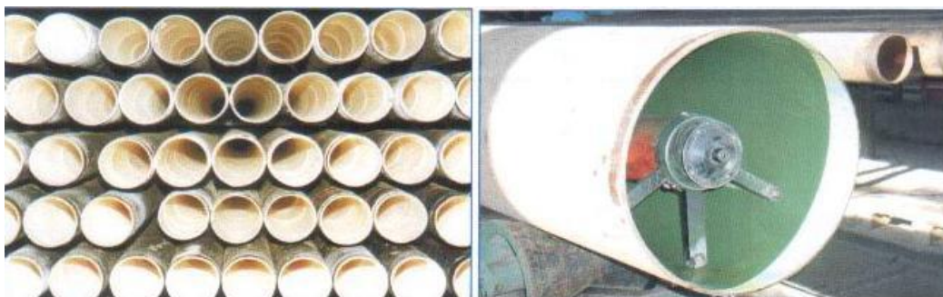
Рис. 5.12. Трубы с покрытием на основе эпоксидно-фенольной смолы
