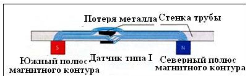
Рис. 5.34. Принцип намагничивания трубопровода и регистрации сигналов датчиками (датчик типа I) [95]
