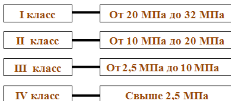
Рис. 1.14. Классификация промышленных трубопроводов для транспорта газа и газового конденсата по величине давления
