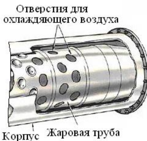
Рис.1.51. Фрагмент камеры сгорания типа «труба в трубе»
