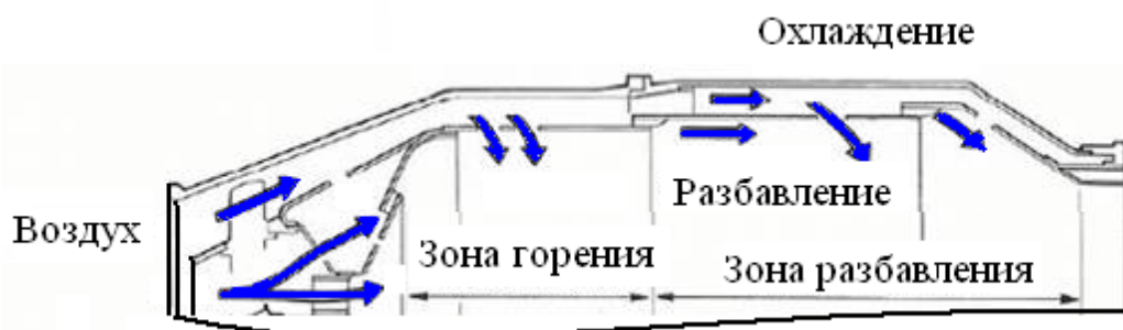
Рис. 1.63. Разделение воздуха на первичный и вторичный потоки
