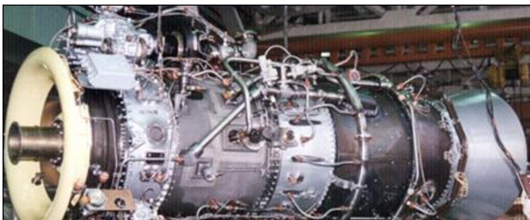
Рис. 1.57. Камеры сгорания встроенные внутрь корпуса
