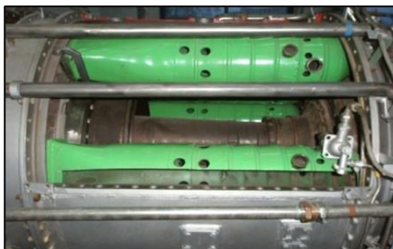
Рис. 1.52. Камеры сгорания типа «труба в трубе» с внутренними перфорированными отверстиями
