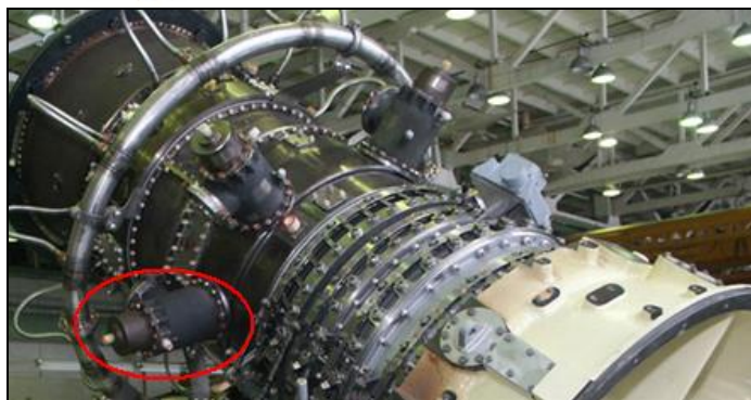
Рис. 1.56. Пример размещения выносных камер сгорания ОАО «Авиадвигатель»:
