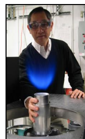
Рис. 2.27. Роберт Чэн демонстрирует горелку своей системы. Он держит руку на корпусе, показывая, что стабильное пламя располагается полностью вне устройства, которое остаётся холодным (фото с сайта lbl.gov ).
