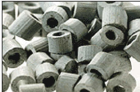
Рис. 1.75. Общий вид каталитического пакета, разработанного Институтом катализа СО РАН, Новосибирской обл., г. Бердск
