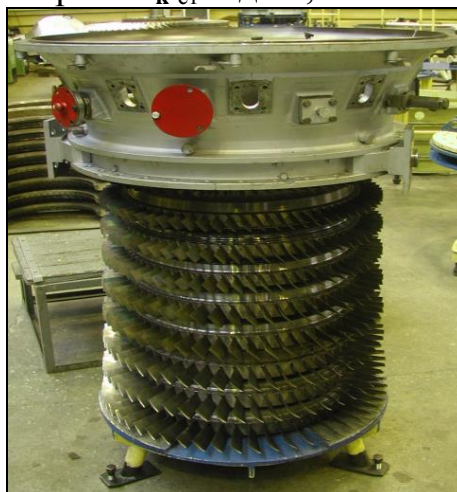
Рис. 1.11. Ротор осевого компрессора с установленными на него рабочими лопатками
