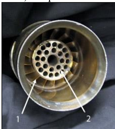
Рис. 2.26. Инжектор LSI: 1 — завихритель потока; 2 — центральные каналы (фото с сайта lbl.gov ).
