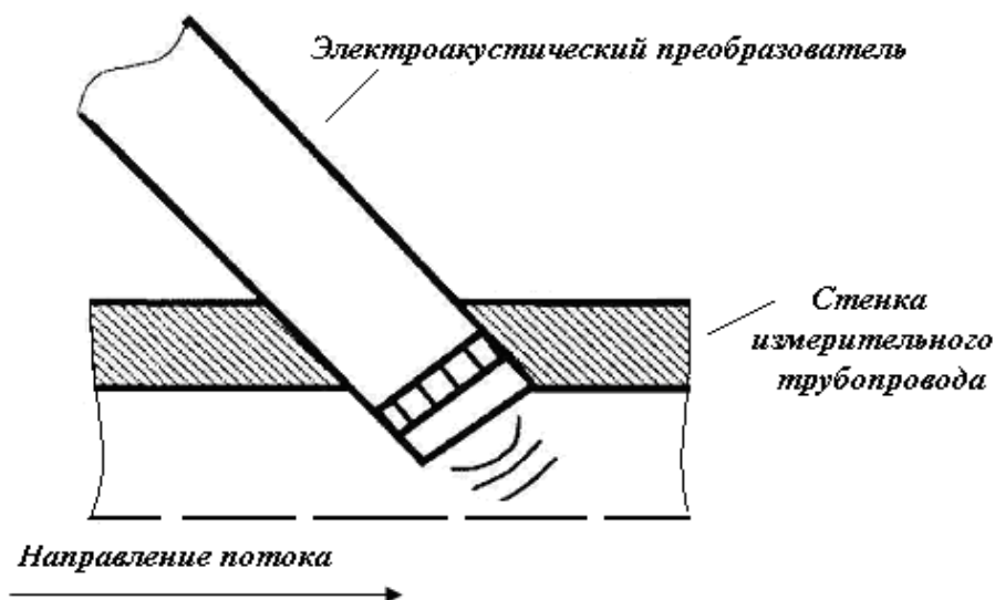
Рис. 3.68. Монтаж электроакустического преобразователя на уровне внутренней стенки измерительного трубопровода
