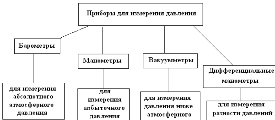
Рис. 2.7. Классификация приборов для измерения давления
