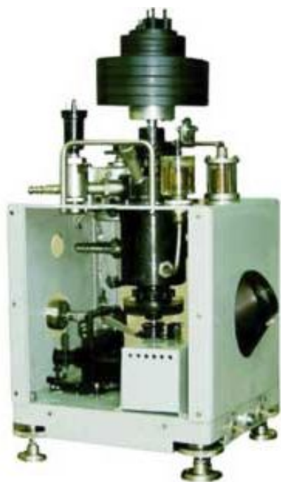
Рис. 2.23. Манометр грузопоршневой образцовый МПА-15
