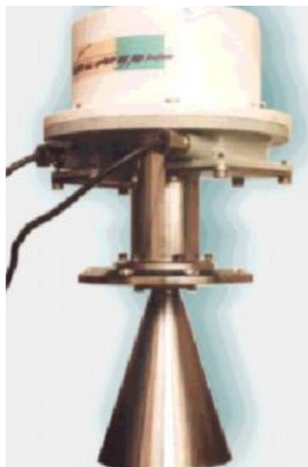
Рис. 2.86. Уровнемер радиолокационный РВР-102 (производитель НПО «Сатурн», Украина)
