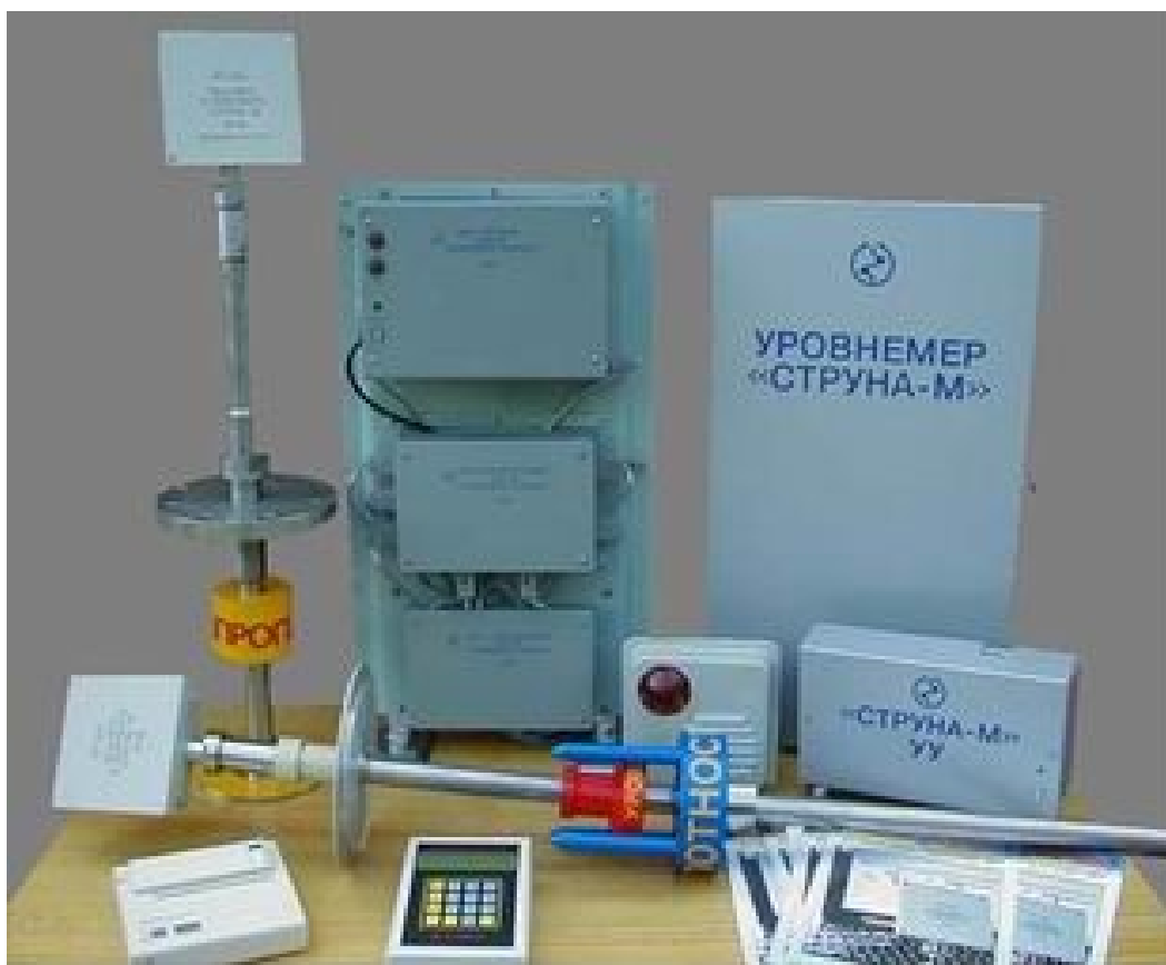
Рис. 2.97. Уровнемер «Струна-М» (производство ЗАО НТФ «Новинтех», г. Королев)
