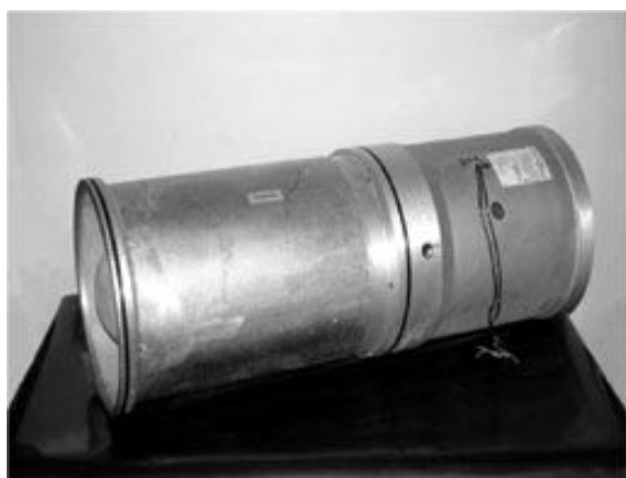
Рис. 3.75. Измерительный преобразователь турбинного счетчика газа TRZ
