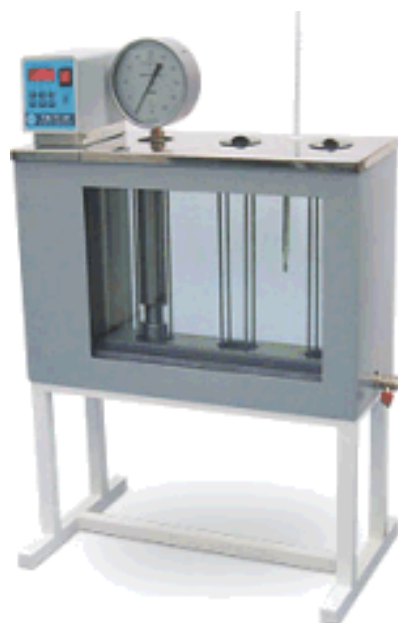
Рис. 3.57. Баня-термостат для бомбы Рейда
