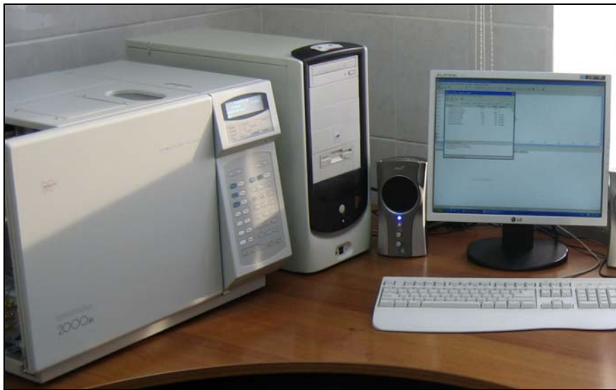
Рис. 4.23. Хроматографический лабораторный комплекс «Кристалл 2000М» для определения компонентного состава природного газа по ГОСТ 23781-87
