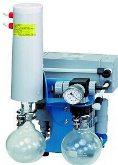
Рис. 3.54. Вакуумная система, включающая в себя вакуумный насос, сепаратор и ловушки с холодильником, производство компании Vacuubrand GmbH, Германия
