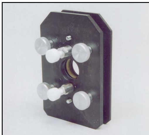
Рис. 2.10. Кювета жидкостная разборная с комплектом прокладок 0,1 ... 1 мм: материал окон KBr и CaF_2
