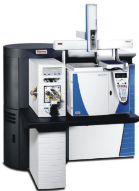
Рис. 2.31. Хромато-масс-спектрометр с двойной фокусировкой высокого разрешения DFS (Швейцария)
