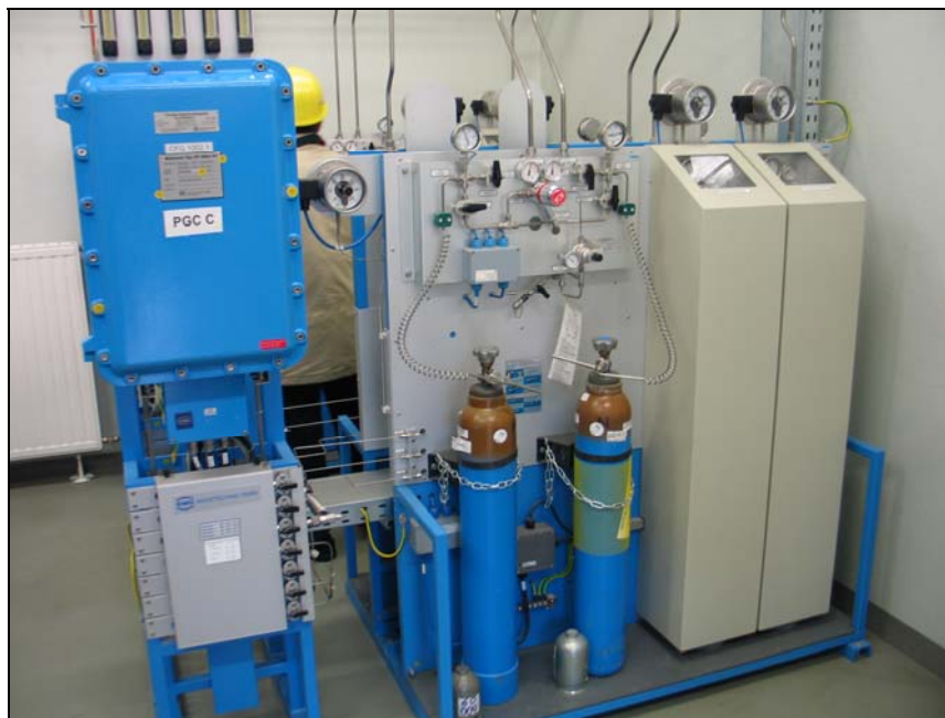
Рис. 4.24. Поточный газовый хроматограф PGC для анализа природного газа
