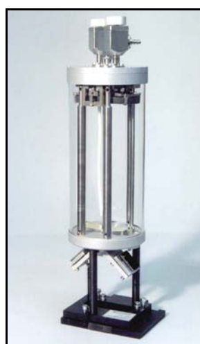
Рис. 2.9. Кювета газовая многоходовая от 0,8 до 4,8 м
