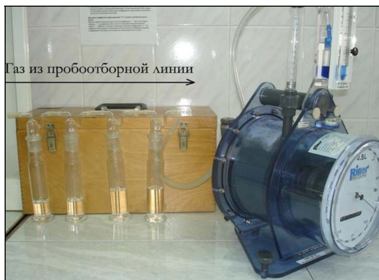
Рис. 4.20. Последовательность соединения поглотительных сосудов и расходомера
