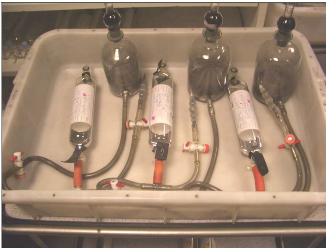
Рис. 4.15. Комплект оборудования для отбора газа без давления
