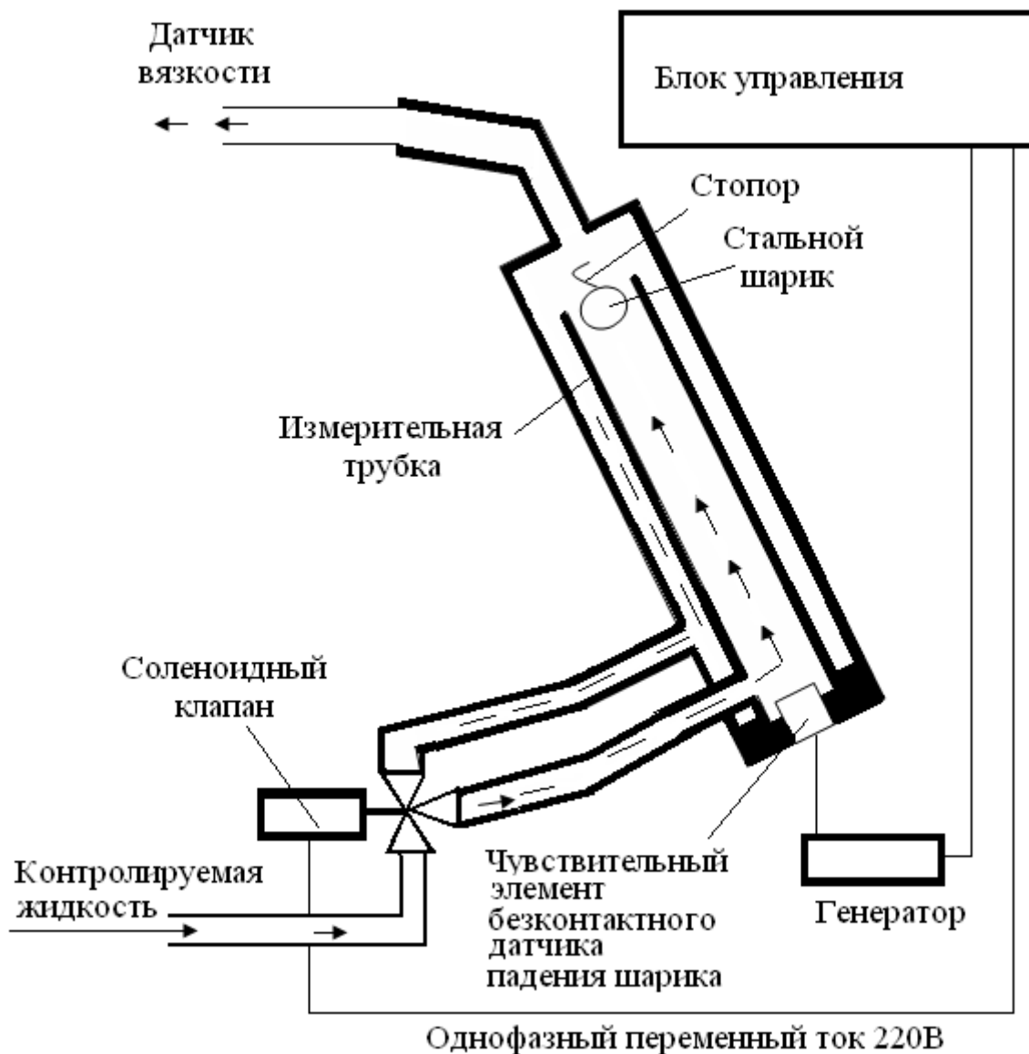
Рис. 3.25. Схема вискозиметра с падающим шариком
