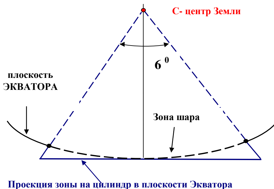
Рис. 7 Проекция зоны на цилиндров плоскости экватора
