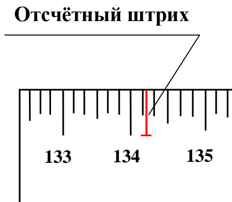
Рис. 37. Принцип отсчета по штриховому микроскопу
