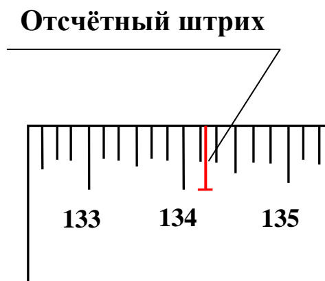
Рис. 37. Принцип отсчета по штриховому микроскопу
