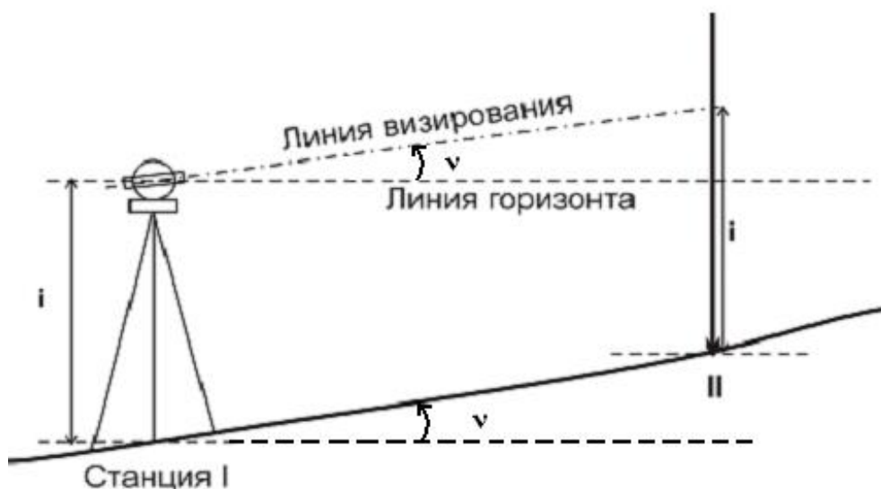
Рис. 2.6. Схема измерения вертикальных углов
