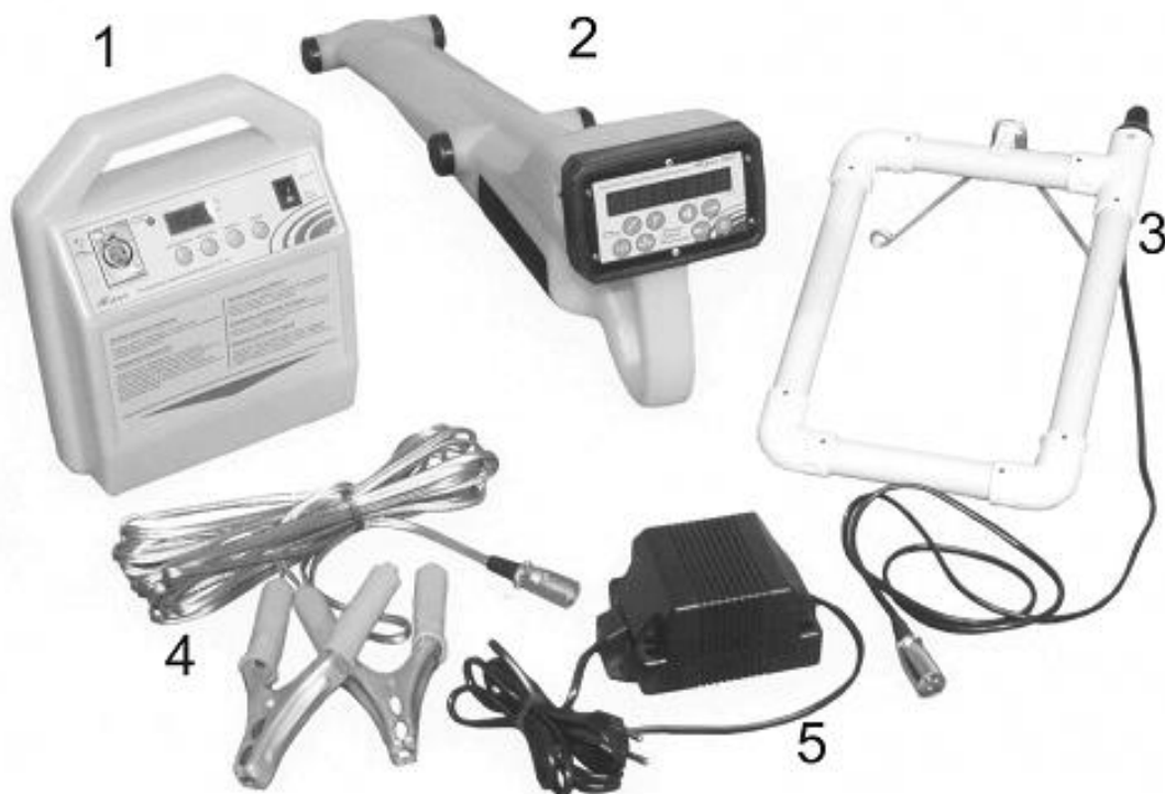
Фото 8.4. Универсальный комплект АБРИС: 1 – генератор; 2 – приемник (локатор); 3 – рамка для поиска дефектов оболочки кабеля; 4 – передающие клещи; 5 – зарядное устройство для генератора
