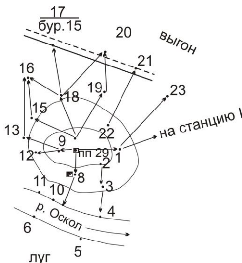
Рис. 4.2. Абрис тахеометрической съёмки
