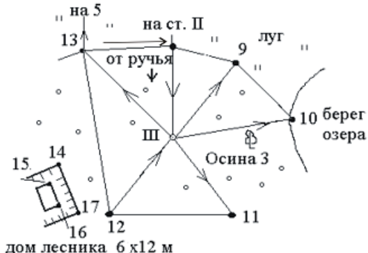
Рис. 4.5. Абрисы тахеометрической съёмки
