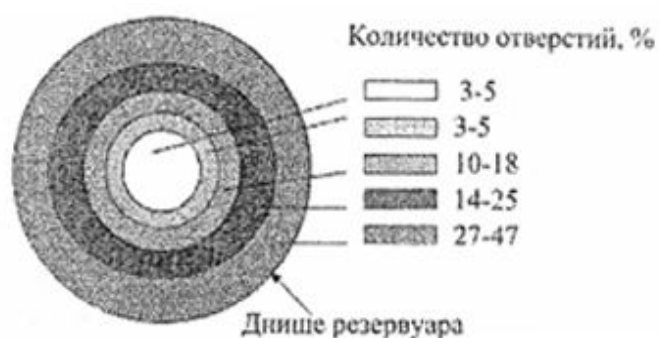
Рис. 6.16. Распределение течей и точечной коррозии на днище
