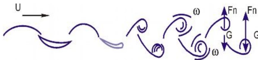
Рис. 6.12. Схема образования вихрей на волновой поверхности раздела фаз «нефть–вода»
