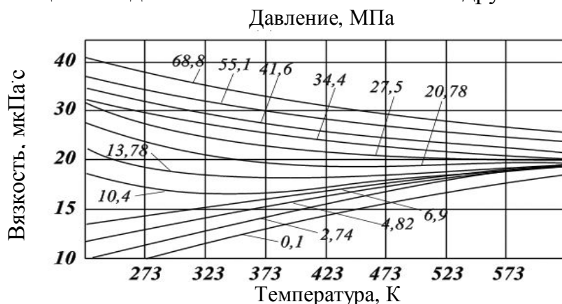
Рис. 1.12. Зависимости коэффициентов динамической вязкости нефтяного газа плотности 0,6 от температуры при различных давлениях
