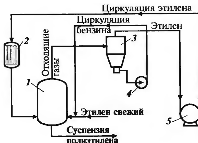
Рис. 27 Схема полимеризации этилена при низком давлении:
