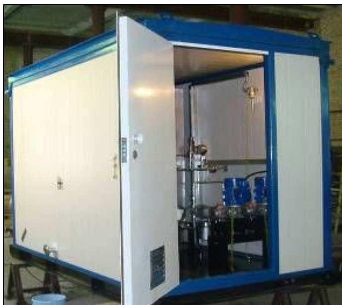
Рис. 16. Общий вид блока дозирования реагентов в отапливаемом укрытии
