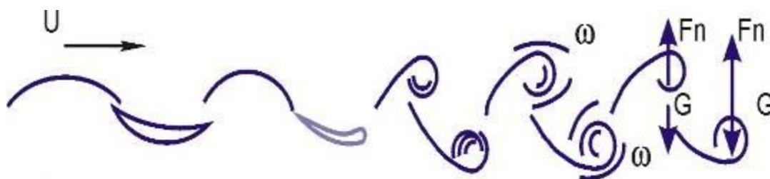
Рис. 8. Схема образования вихрей на волновой поверхности раздела фаз нефть–вода
