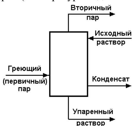
Рис. 4.1. Схема материальных потоков в выпарном аппарате
