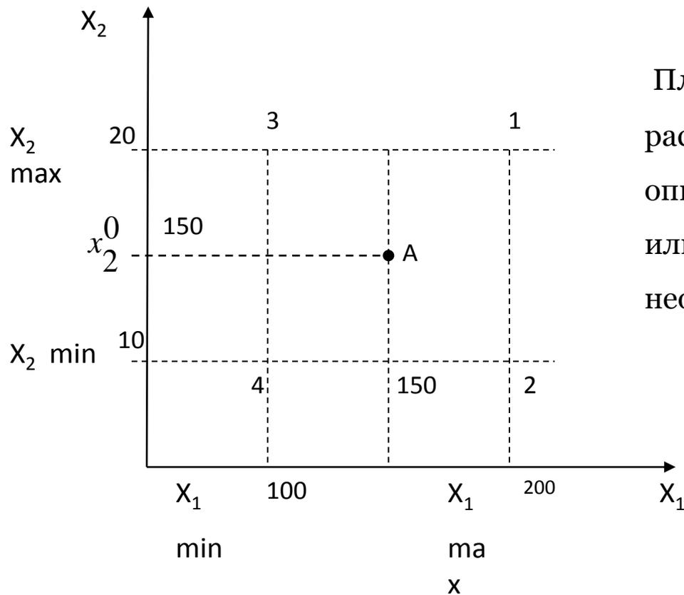
План эксперимента указывает расположение  $n$ -мерном пространстве опытных точек независимых переменных или условия всех опытов, которые необходимо провести
