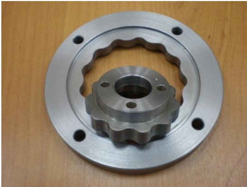
Рис. 2. Пример изготовления кулачка на аппаратно-программном комплексе
