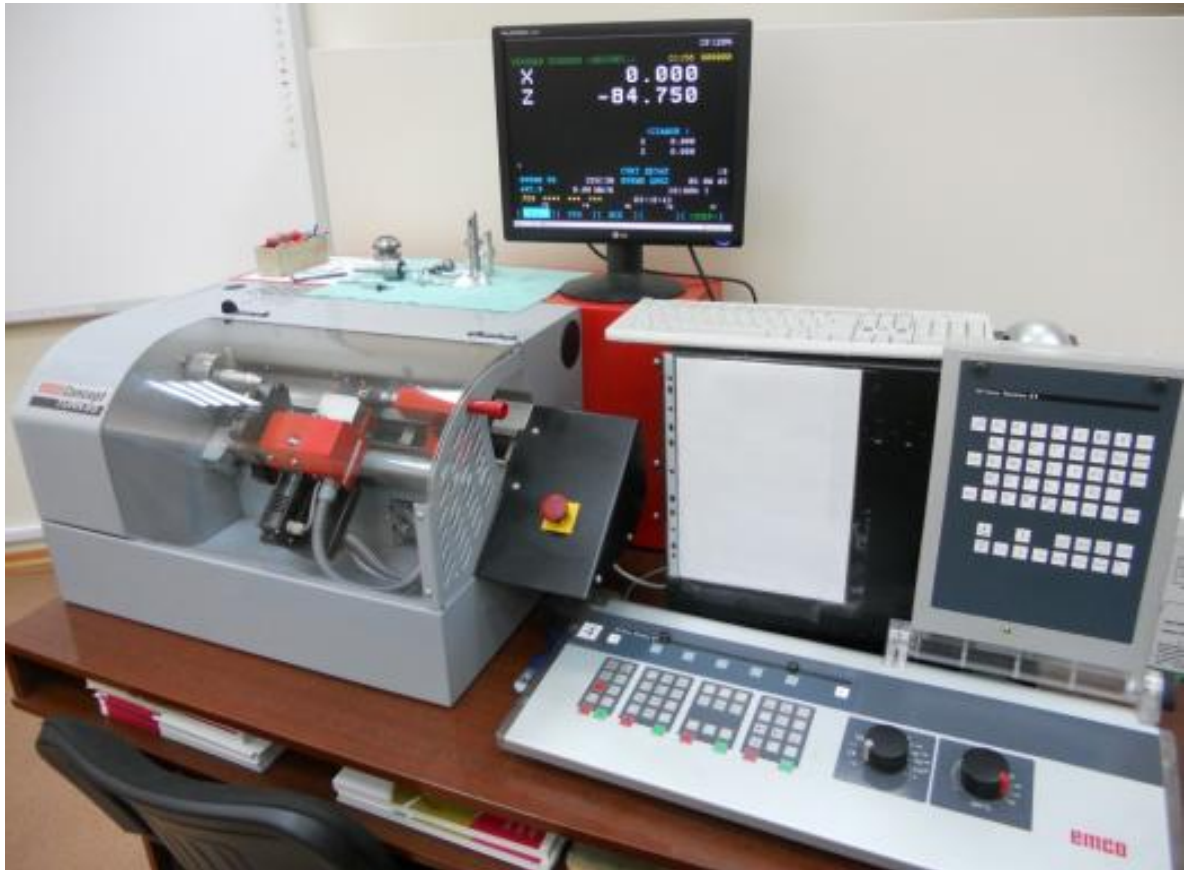
Рис. 1. Отладка управляющей программы и обработка детали на токарном станке с ЧПУ
