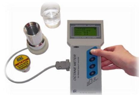
**Октановое число** - процентная доля изооктана в смеси с н-гептаном, детонирующей при той же степени сжатия.
