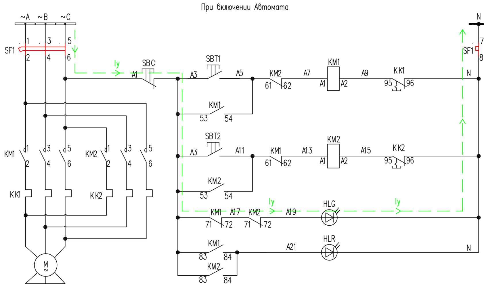
Включение автоматического выключателя. После того, как автоматический выключатель взведен, электрический ток протекает по цепи – фаза С, НЗ кнопка "Стоп" (SBC), НЗ дополнительные контакты контакторов (KM1: 71–72 и KM2: 71–72) подключенные последовательно, зеленая лампа (HLG), шина N. Загорается зеленая лампа "Отключен" (HLG) сигнализирующая, что двигатель отключен, схема готова к работе.
