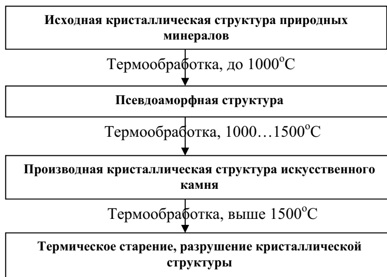
Рис. 4.1. Схема структурных изменений в техническом камне при термообработке
