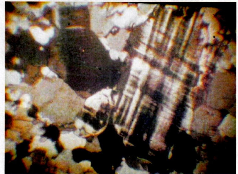
Рис. 47. Микроклин. Николи +. Форма близка к изометричной. Характер погасания решётчатый. Сила двойного лучепреломления \sim 0,007 .
