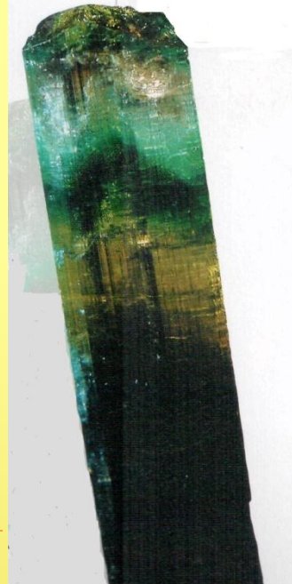
Рис. 7.23. Кристалл турмалина с симметрией 3m проявляющий пьезоэлектрические свойства
