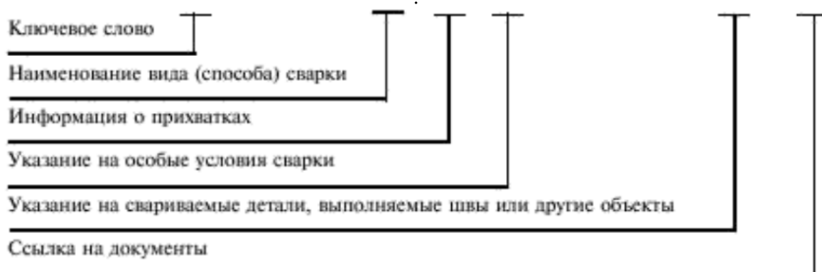
Рис. 5. Общая схема записи перехода
