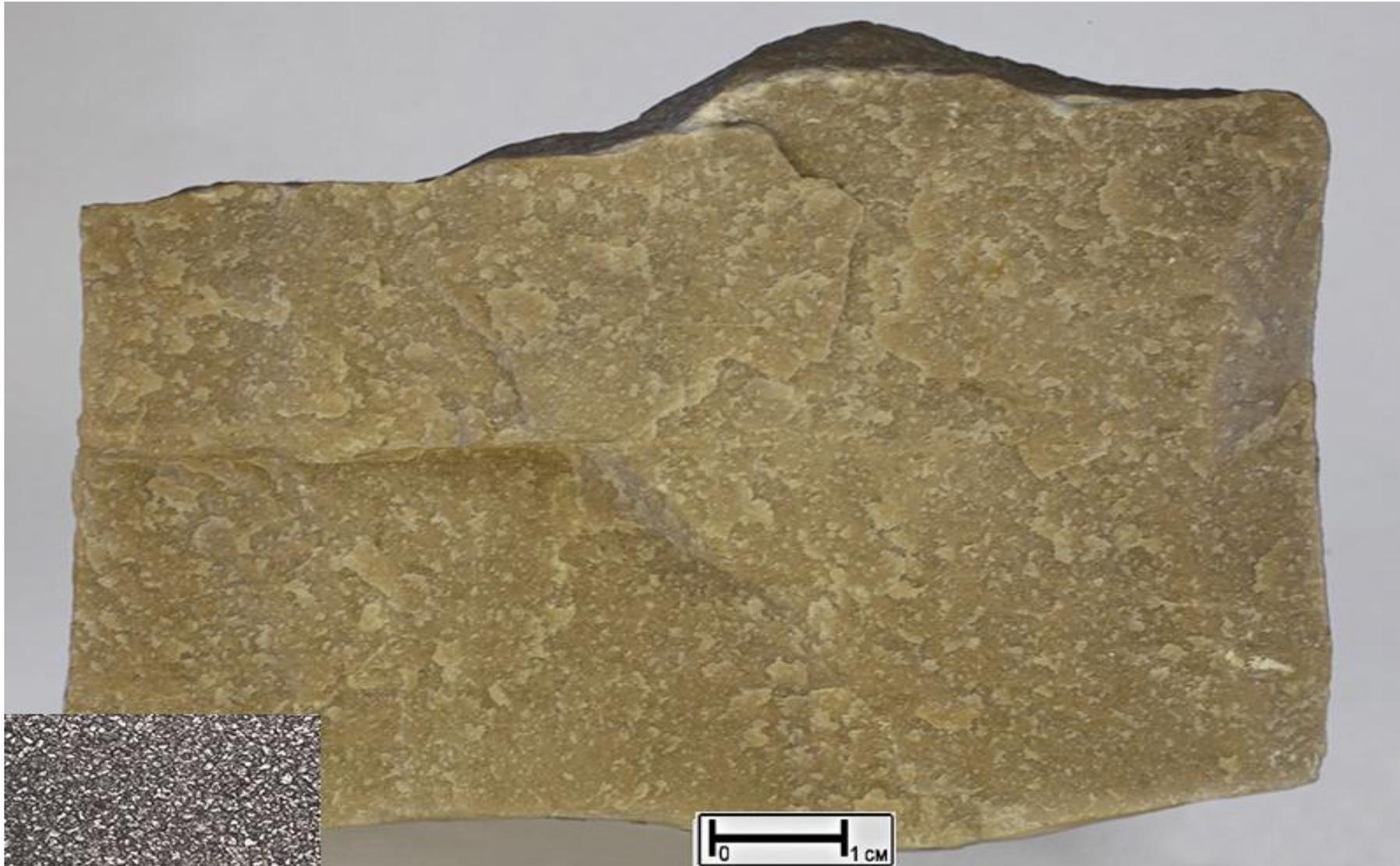
Порода плотная, сливная, сложена мелкозернистым однородным доломитом. Цемент глинисто-карбонатный. Структура кристаллическизернистая.
