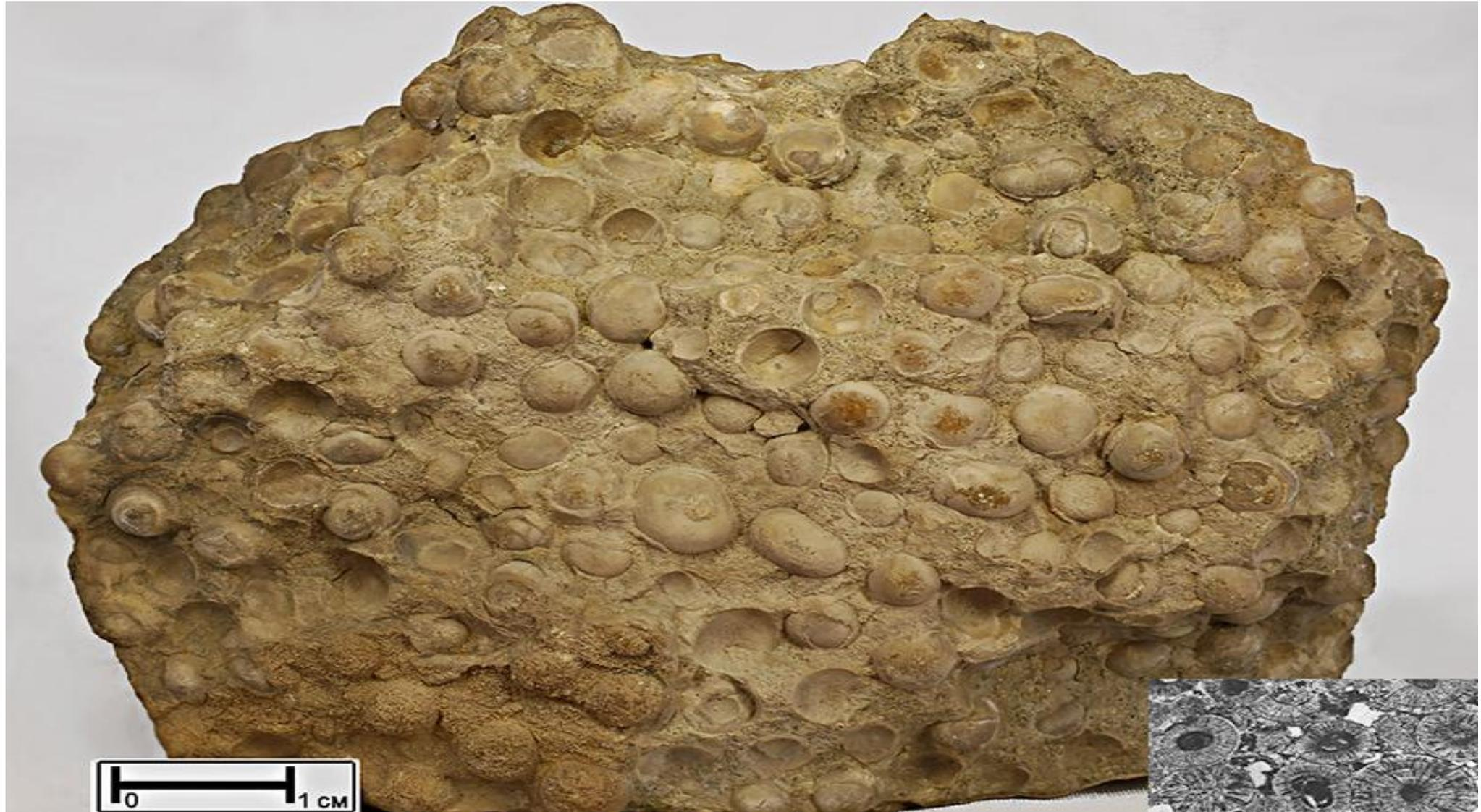
Порода состоит из кальцитовых округлых, реже овальной формы оолитов (0,5 мм), сцементированных кальцитовым цементом. Структура оолитовая. Текстура неясно слоистая, скорлуповатая. *Источник:* петрографический справочник-определитель ([http://rockref.vsegei.ru/petro/pages/Sedimentary\\_rocks/carbonaceous\\_group/limestone.html](http://rockref.vsegei.ru/petro/pages/Sedimentary_rocks/carbonaceous_group/limestone.html))
