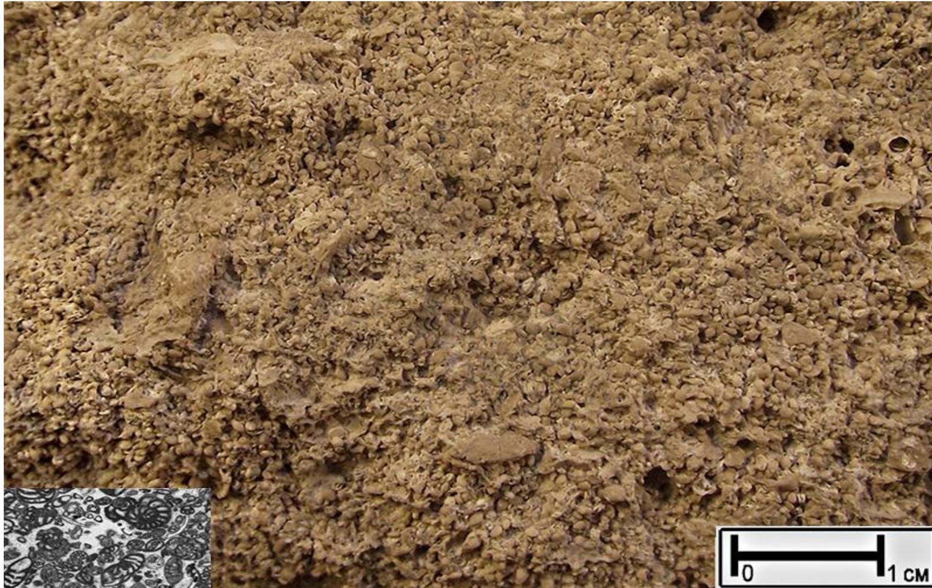
Для породы характерно присутствие многочисленных породообразующих раковин фораминифер, сцементированных карбонатным веществом. Структура органогенная, биоморфная. Текстура слоистая, пористая. *Источник:* петрографический справочник-определитель ([http://rockref.vsegei.ru/petro/pages/Sedimentary\\_rocks/carbonaceous\\_group/limestone.html](http://rockref.vsegei.ru/petro/pages/Sedimentary_rocks/carbonaceous_group/limestone.html))
