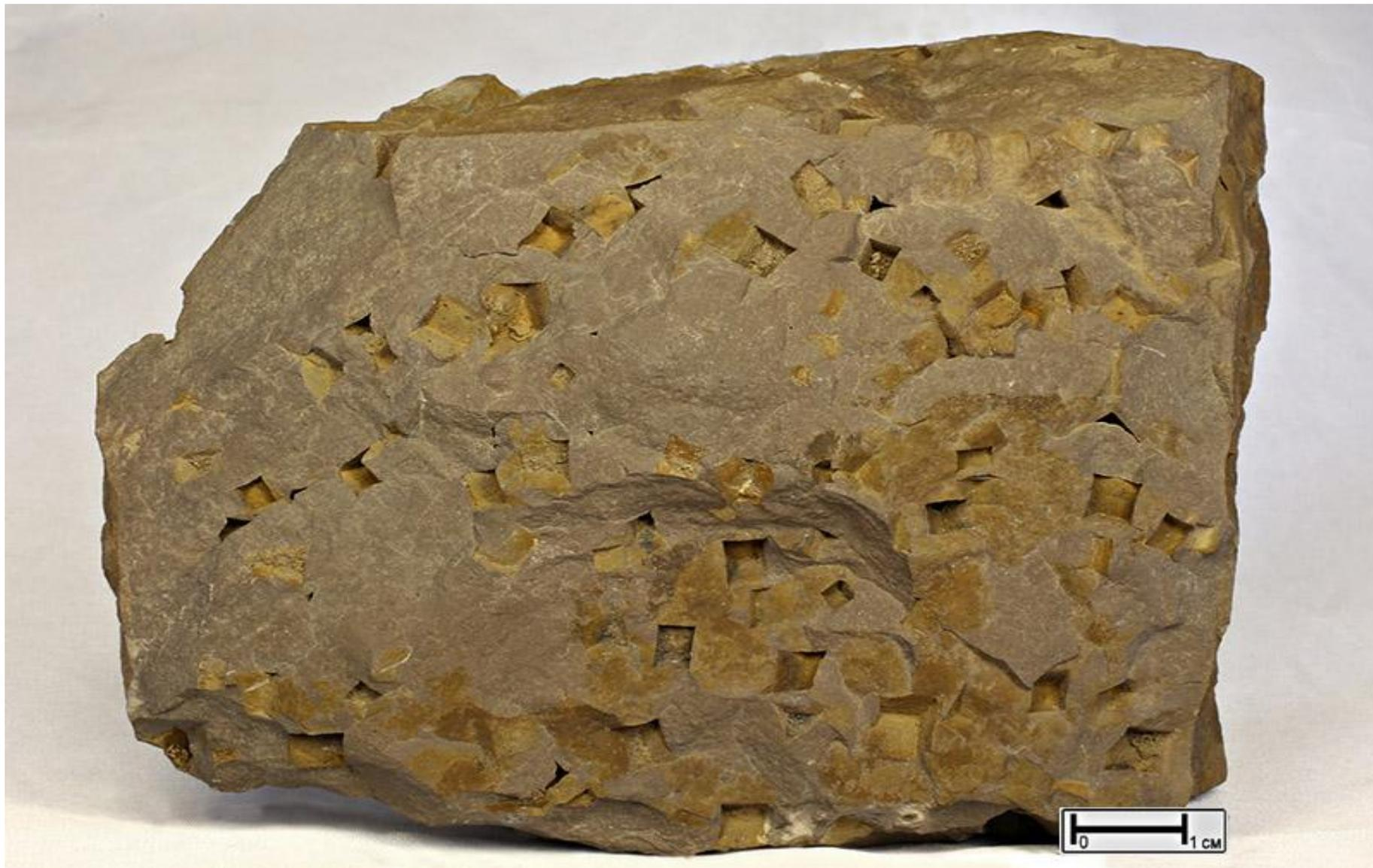
В породе видны пустоты выщелачивания кубических кристаллов каменной соли. Минеральный состав: доломит. Структура тонкозернистая. Текстура выщелачивания. *Источник:* петрографический справочник-определитель ([http://rockref.vsegei.ru/petro/pages/Sedimentary\\_rocks/carbonaceous\\_group/limestone.html](http://rockref.vsegei.ru/petro/pages/Sedimentary_rocks/carbonaceous_group/limestone.html))
