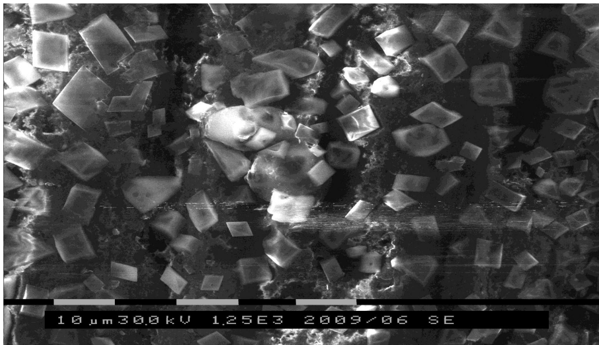
Рисунок 3.31 – Фотография поверхности графит-полимерного электрода. Соотношение графитового порошка к мономеру ММА 50:50 %
