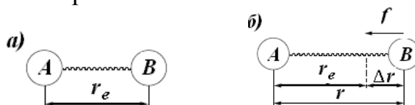
Рис. 1.6. а – модель молекулы AB из двух атомов, соединенных упругой химической связью; б – система AB в состоянии смещения на расстояние \Delta r
