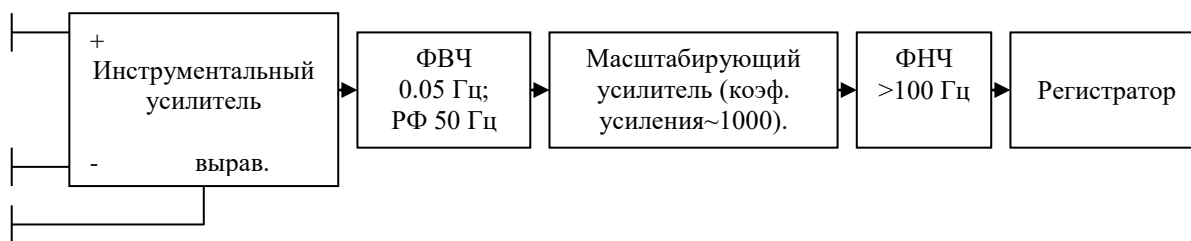
Рис. 2.3. Структура усилительного тракта аналогового электрокардиографа
