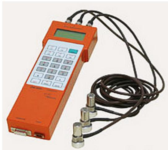
*Рис. 36. Устройство виброизмерительное СМ-300*
