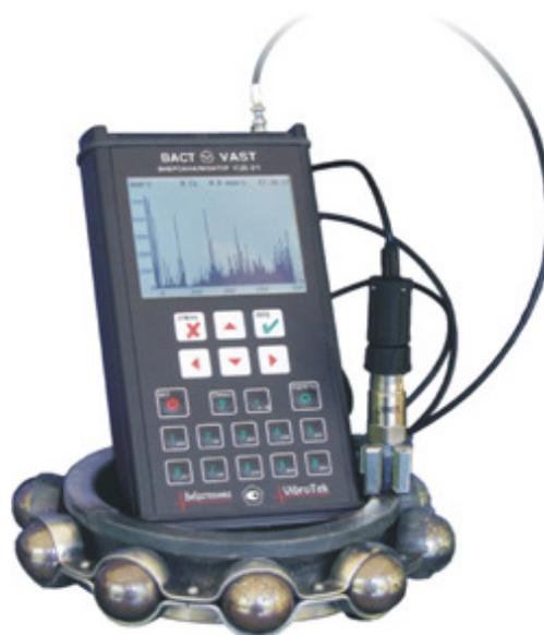
*Рис. 37. Виброанализатор СД-21*
