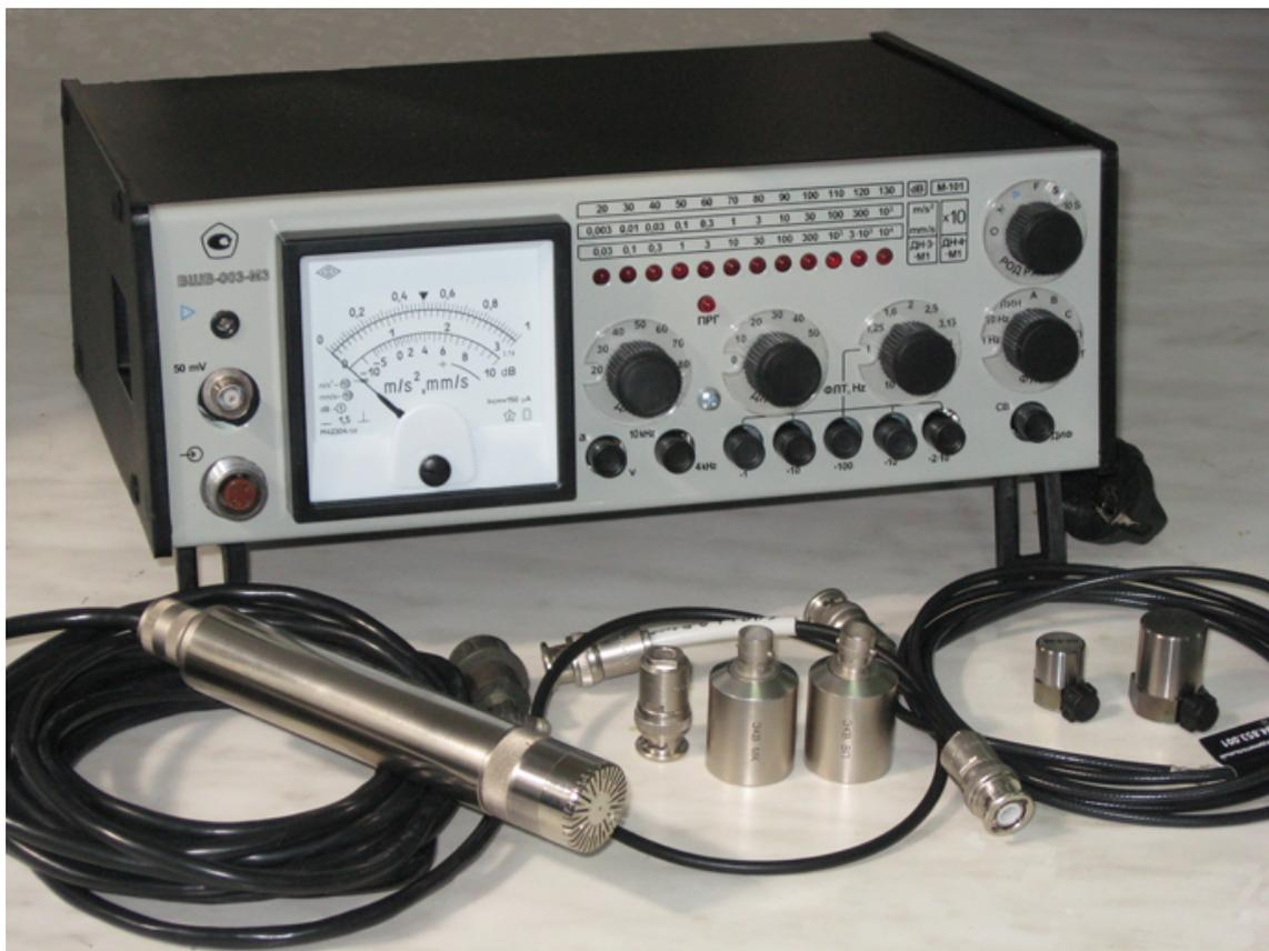
Рис. 34. Измеритель шума и вибрации ВШВ-003-М3
