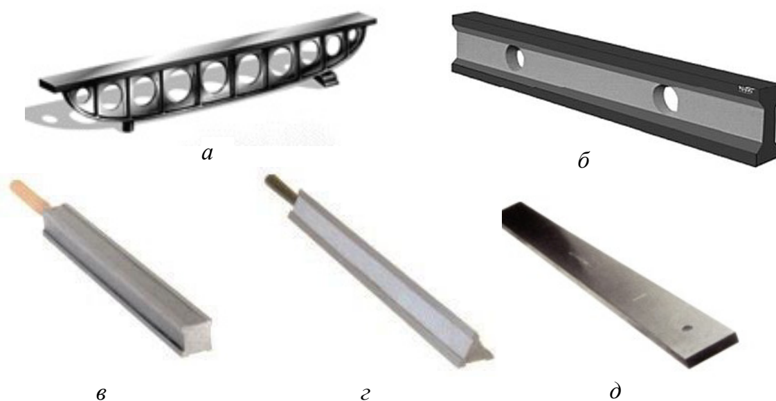
Рис. 45. Примеры конструктивного исполнения поверочных линейек: а – в виде мостика; б – двутаврового сечения; в – четырехгранные; г – трехгранные; д – прямоугольные
