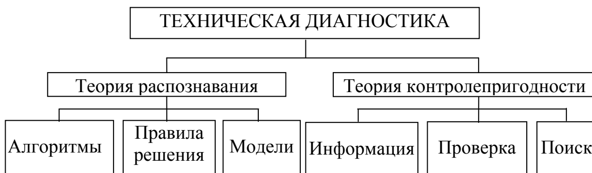
Рис. 1. Структура технической диагностики
