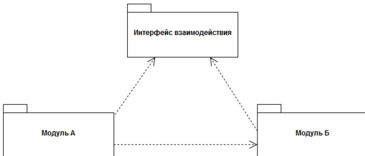
Рис. 2.3. – Взаимодействие программных модулей через интерфейс Диаграмме пакетов на рисунке 2.3 соответствует диаграмма классов, представленная на рисунке 2.3.1.
