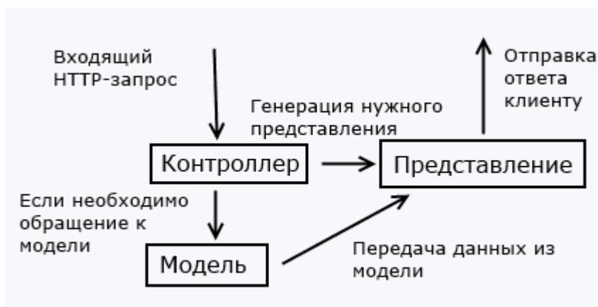
В этой схеме модель является независимым компонентом - любые изменения контроллера или представления не затрагивают модель. Контроллер и представление являются относительно независимыми компонентами, и нередко их можно изменять независимо друг от друга.
